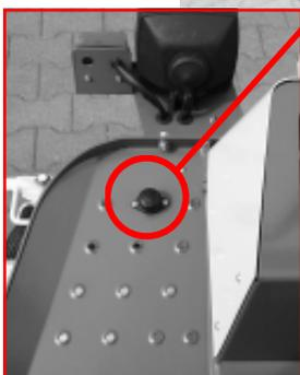
Fußschalter um die Geradeausstellung der Lenkräder einzuleiten, unabhängig vom aktuellen Betriebszustand. Dies kann z.B. beim Befahren von Verloaderampen hilfreich sein.
