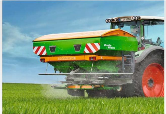
Doch nicht nur das Streuwerk, Rahmen und Behälter sind bis ins Detail durchdacht, sondern auch alle Zubehörteile sind neu konstruiert: So findet man eine fest montierte Rollvorrichtung die für den Feldeinsatz geschickt weggeklappt werden kann. Oder eine moderne hydraulisch betätigte Rollplane, die den Dünger während der Arbeit vor Feuchtigkeit und Schmutz schützt und zum Beladen entweder komplett wegrollt oder als Einfüllhilfe für die Frontladerbefüllung genutzt werden kann.
