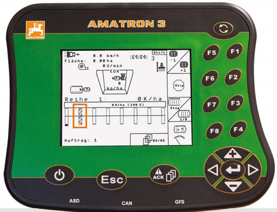
Anzeige des geschlossenen Moduls (orange Markierung) auf dem AMATRON 3
