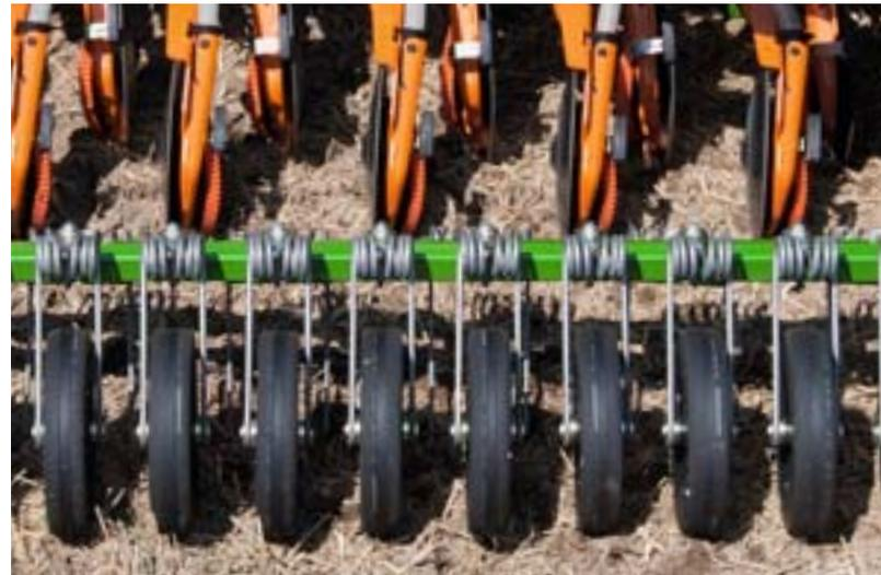
*Saatgutablage über das RoTeC<sup>+</sup>-Control-Schar mit 400 mm Durchmesser und bis zu 55 kg direkt wirkendem Schardruck. Perfekte Einebnung und Bedeckung durch Exakt- oder Rollenstriegel.*
