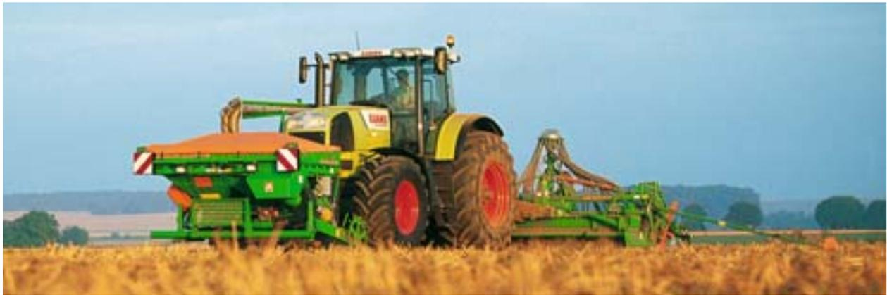
*Pneumatische Fronttank-Säkombination Avant*
