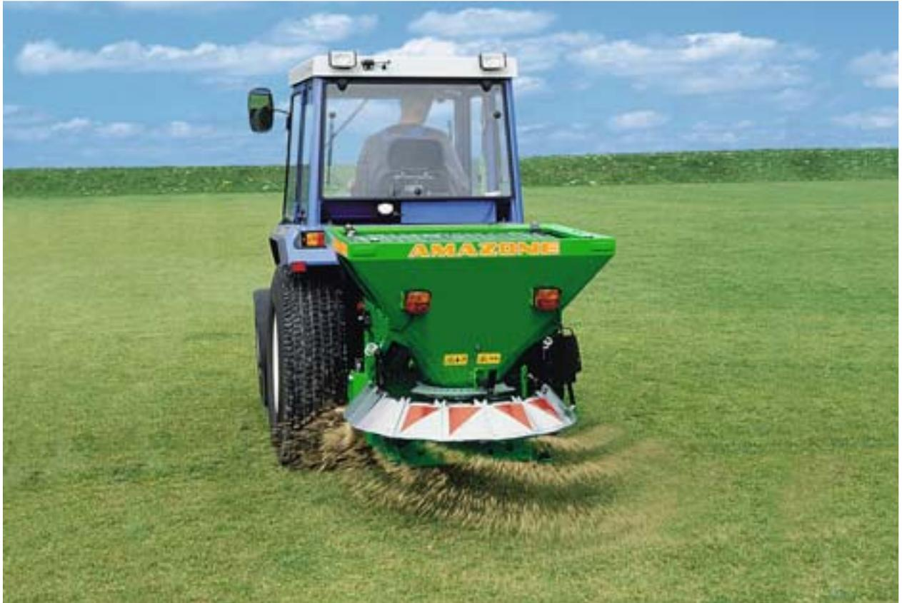
*Ohne Umbau wird der AMAZONE Streuer E+S zum Besander und arbeitet den Sand gleichmäßig in den Rasen ein. Ein zusätzliches Einkehren und Aufrichten der Gräser ist nicht erforderlich.*
