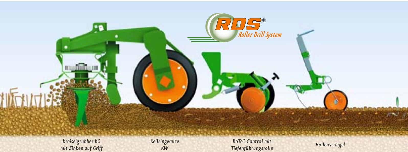
Durch den Entmischungseffekt des Kreiselgrubbers werden gröbere Erdteile an der Oberfläche abgelegt. Feinerde verbleibt im Saathorizont für hervorragende Keimbedingungen. Das Saatgut kommt somit in den Bereich, in dem die Feinerde liegt. Die größeren Teile an der Oberfläche schützen vor Verschlämmung, Austrocknung und Erosion. Das „Roller Drill System“ mit Keilringwalze, RoTeC-Control-Schar und Rollenstriegel sorgt für verbesserten Saataufgang und Mehrerträge.
