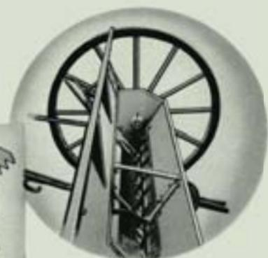
Blick in den einfachen Streukasten. Die Streurechen (rechts) sind für feuchten Dünger bestimmt und werden nur eingehängt.
