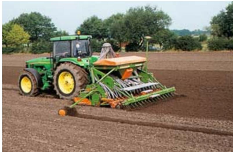
Pneumatische Aufbausämaschine Airstar Progress
