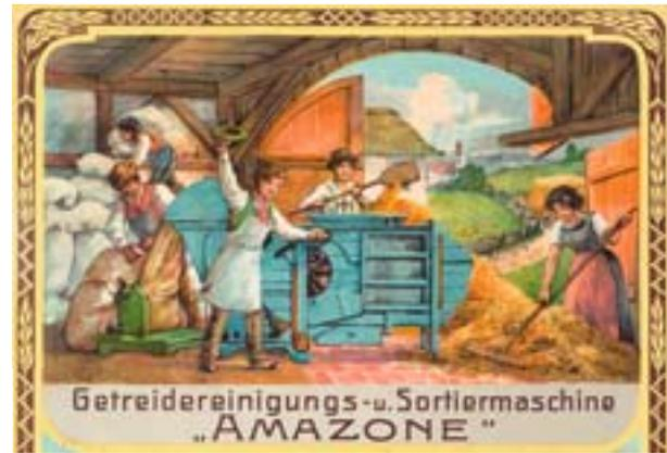
schine, die das Getreide nicht nur reinigte, sondern auch sortierte. Sie lieferte sauber gereinigte Ware, aus der auch zu kleine Körner und Bruchgetreide aussortiert wurden, also fertiges Saatgetreide. Mit dieser Maschine erhielt er 1891 auf einer bedeutenden landwirtschaftlichen Ausstellung in Bremen die Auszeichnung: **Beste Maschine**.
