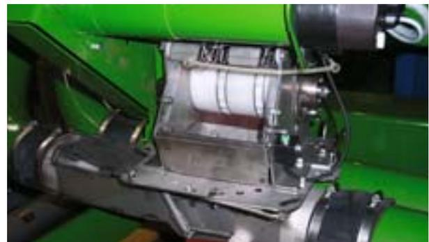
*Die Dosierwalzen lassen sich in dem Dosierer leicht wechseln. So ist es möglich für alle Saatgüter und Saatmengen auch bei hohen Arbeitsgeschwindigkeiten präzise mit guter Längsverteilung zu dosieren.*
