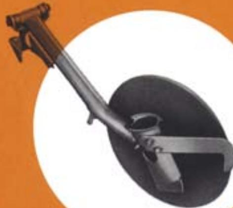
*Auch 1979 war bezüglich der AMAZONE Sätechnik ein besonders wichtiges Jahr: AMAZONE rüstete erstmalig Sämaschinen (D7) mit sogenannten Rollscharen aus. Eine Entwicklung, die bis in die Gegenwart eine immer stärker werdende Bedeutung erlangt (Mulchsaat).*
