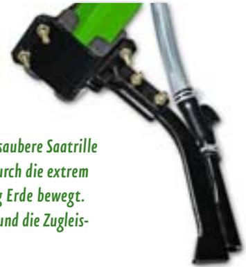
*Das TineTeC-Schar formt eine saubere Saatrille frei von organischer Masse. Durch die extrem schmale Bauweise wird wenig Erde bewegt. Vorteile: Wasser wird gespart und die Zugleistung der Maschine minimiert.*
