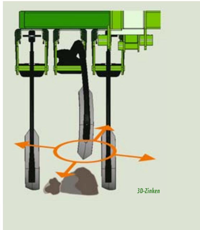
*Centaur mit integriertem Laufwerk, Keilringreifenwalze und 3D-Zinken*
