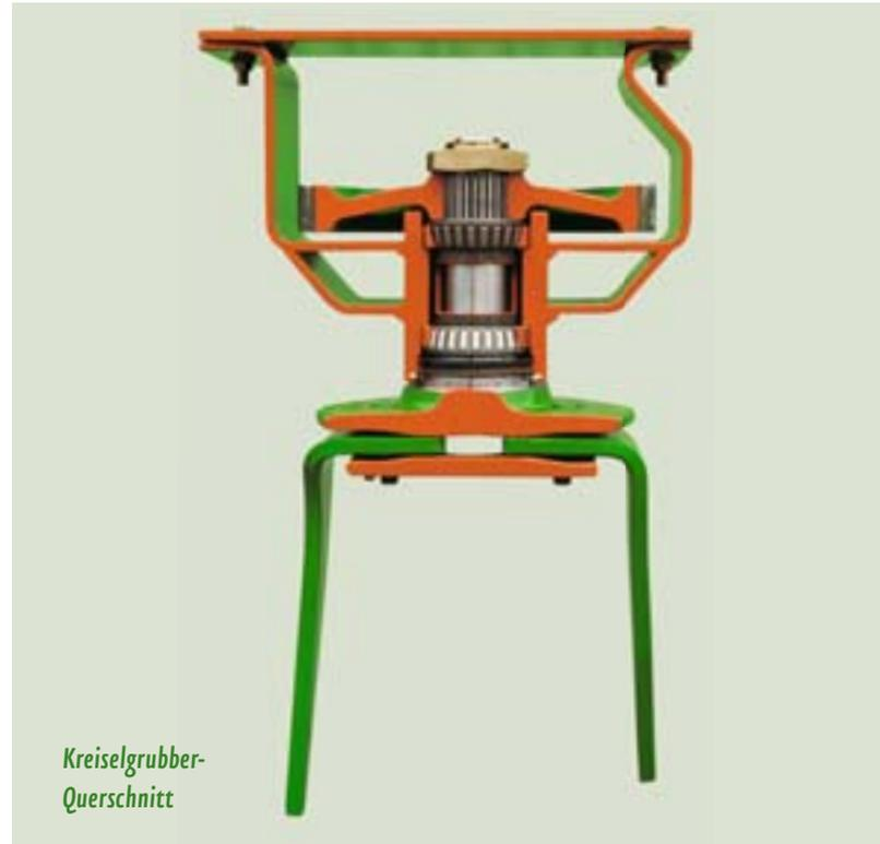
ken. Diese Zinken weichen, wenn sie auf ein Hindernis treffen, in einer Tasche bis zu 7 cm nach hinten aus. Der entstehende Schlag belastet somit weder die Maschine noch das Getriebe.
