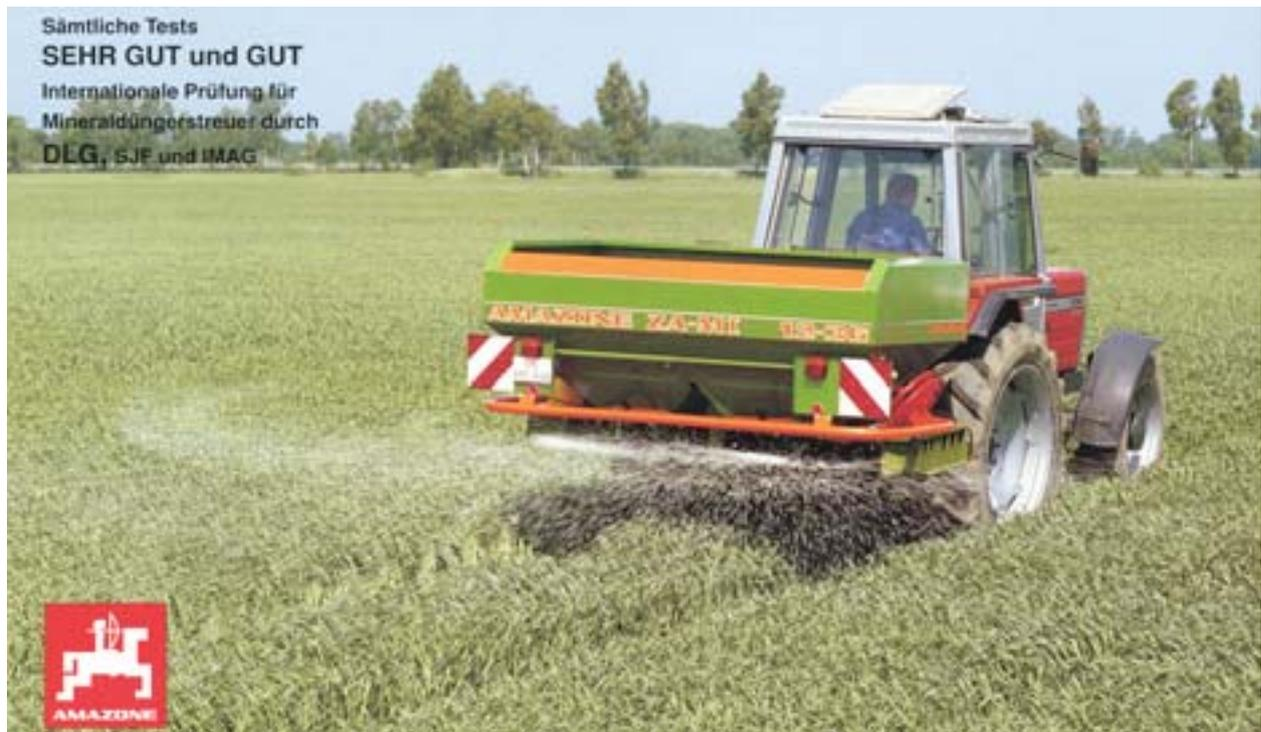
breite bis 52 m und der ZA-M Ultra Profis Hydro mit Wiegeeinrichtung, hydraulischem Antrieb und einer Arbeitsbreite bis zu 52 m. Das maximale Fassungsvermögen beträgt 4.200 l.
