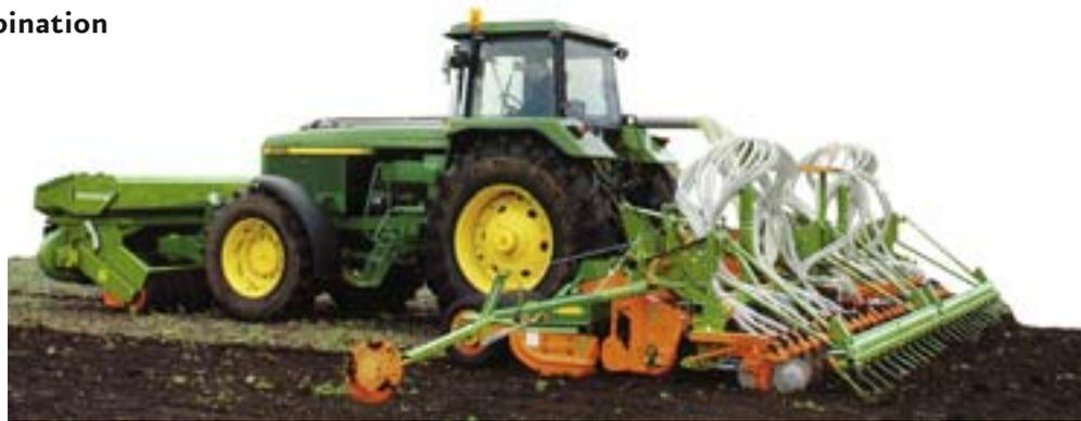
*Pneumatischer Frontpacker-Sätank und 6-m-Kreiselgrubber mit Reifenpacker-Sämaschine*
