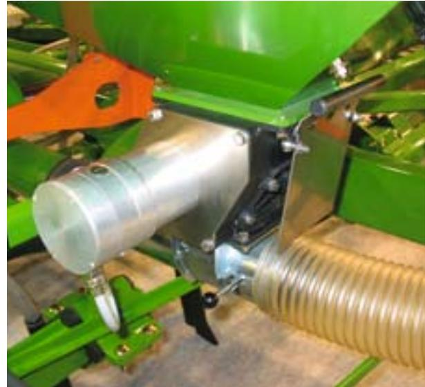
*Die bewährte elektrische Volldosierung ermöglicht eine präzise Einstellung der Saatgutmenge. Es muss lediglich die Aussaatmenge am Bedienterminal eingestellt, die Maschine abgedreht und das ermittelte Gewicht in das Terminal eingegeben werden.*
