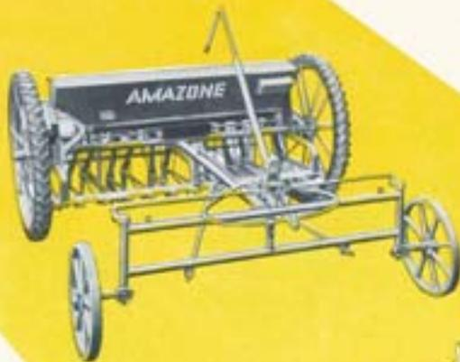
Nebestehende Abbildung zeigt die AMAZONE Drillmaschine, Normalmodell D 3, mit Gummibereifung 4,00—36 und mit dem neuen Getriebe. Die Gummiräder sind sowohl für die Drillmaschine als auch für den AMAZONE Düngerstreuer austauschbar zu verwenden. Durch die beiden Stellhebel beim Getriebe können
