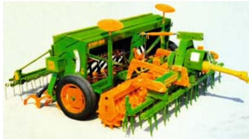
Rüttelegge, Zahnpackerwalze und Sämaschine D7
