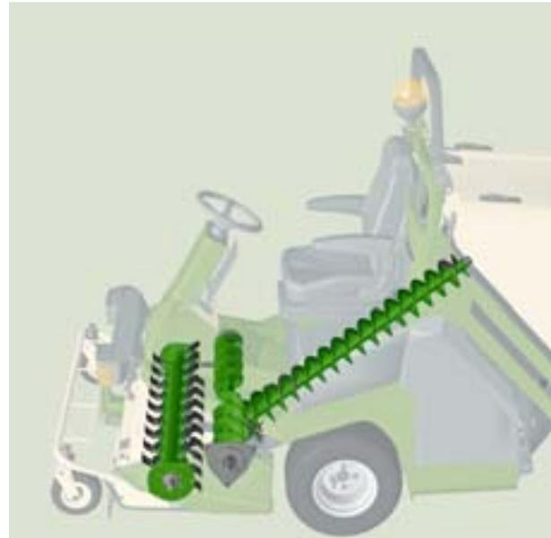
*Das Mähgut wird sofort nach dem Aufnehmen in ein Förderschneckensystem geführt, verdichtet und im Fangkorb gesammelt. Durch das Verdichten des Mähgutes wird das Ist-Volumen des Behälters von 730 l auf einen Nutzinhalt von bis zu 1.000 l erhöht.*
