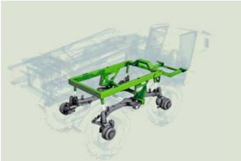
*Das spezielle Tandemfahrwerk des Pantera sichert nicht nur eine gute Anpassung an Bodenunebenheiten, sondern auch eine hohe Standsicherheit – natürlich auch am Seitenhang. Dank der niveauregulierten, hydropneumatischen Federung genießt der Fahrer des Pantera zudem einen optimalen Komfort.*
