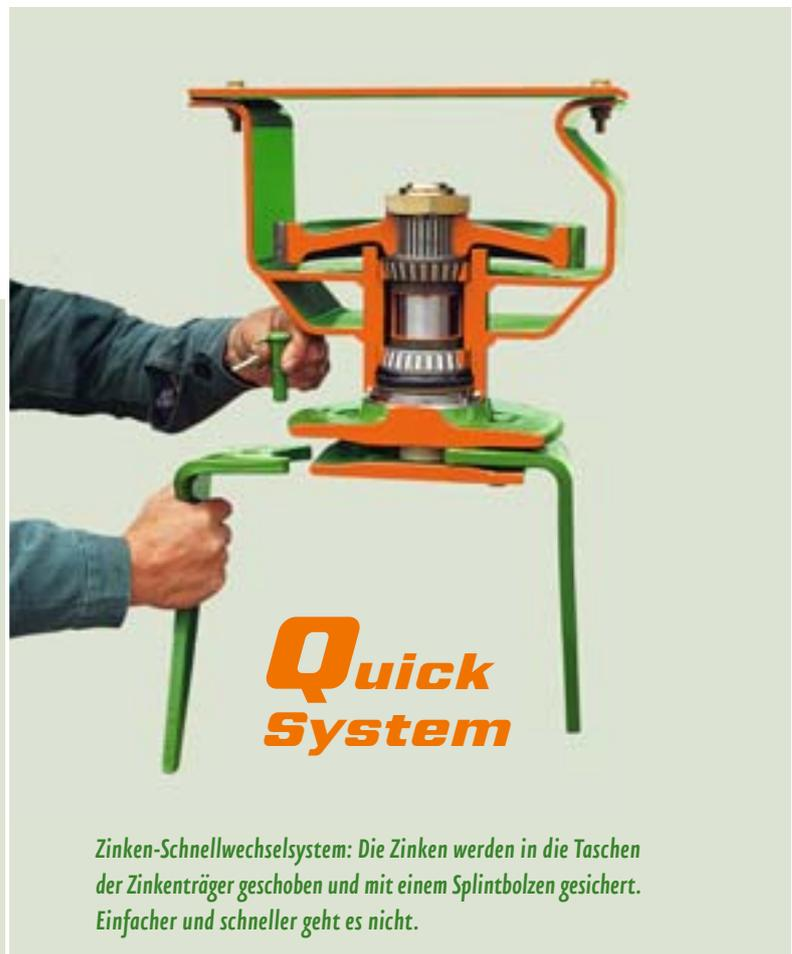
Zinken-Schnellwechselsystem: Die Zinken werden in die Taschen der Zinkenträger geschoben und mit einem Splintbolzen gesichert. Einfacher und schneller geht es nicht.
