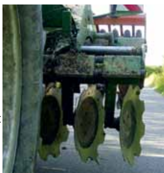
In Transportstellung ist die Catros drei Meter breit. Dazu verschieben sich die Scheibenreihen seitlich.
