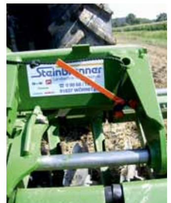
Die Transportverriegelung lässt sich per Seilzug von der Kabine aus lösen.
