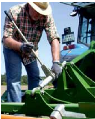
Mittels eingebauter Ratsche lässt sich die Walze und damit die Arbeitstiefe verstellen.
