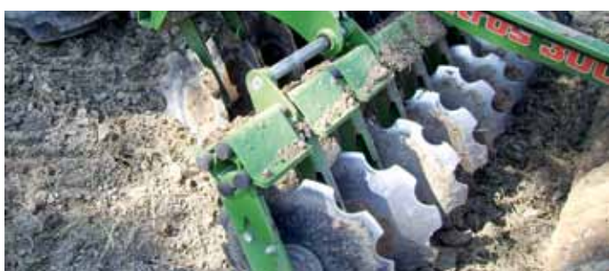
Die gezackten Scheiben der Catros + haben einen Durchmesser von 510 Millimeter.
