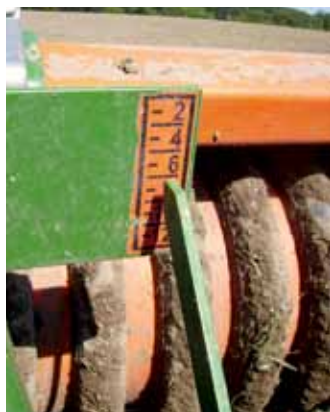
Die gut sichtbare Anzeige (leider nur aufgeklebt) gibt in etwa die Arbeitstiefe in Zentimeter an.
