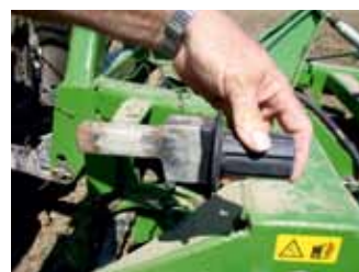
Der exzentrische Vierkantbolzen dient als Anschlag beim Einstellen des Scheibenversatzes.
