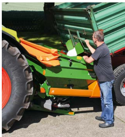
Napełnianie z wywrotki
