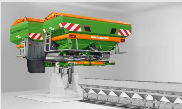
Nowoczesna hala testowa rozsiewaczy nawozów
