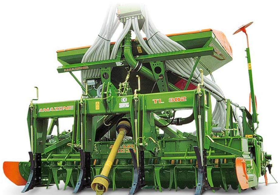
Tiefenlockerer an der Säkombination auf 30 cm Tiefe gestellt. Diese Verfahrenskombination braucht viel Kraft, sodass der Traktor bei 8 km/h Arbeitstempo auf einen Kraftstoffverbrauch von 30 bis 32 l/Stunde kommt. Im Pflugsaatverfahren – ohne Frontgrubber – liegt der Kraftstoffverbrauch nur noch bei rund 20 l/Stunde. Die Flächenleistung der Säkombination liegt im Schnitt bei 1,8 ha/Stunde.
