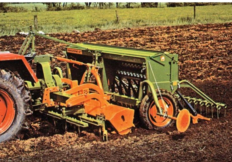
1972: Anbausämaschine D7 mit Rüttelegge RE, starrem Zinkenbalken und Zahnpackerwalze
