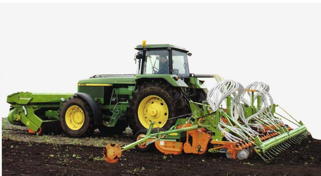
1995: Pneumatischer Frontpacker-Sätank und 6-m-Kreiselgrubber mit Reifenpacker-Sämaschine
