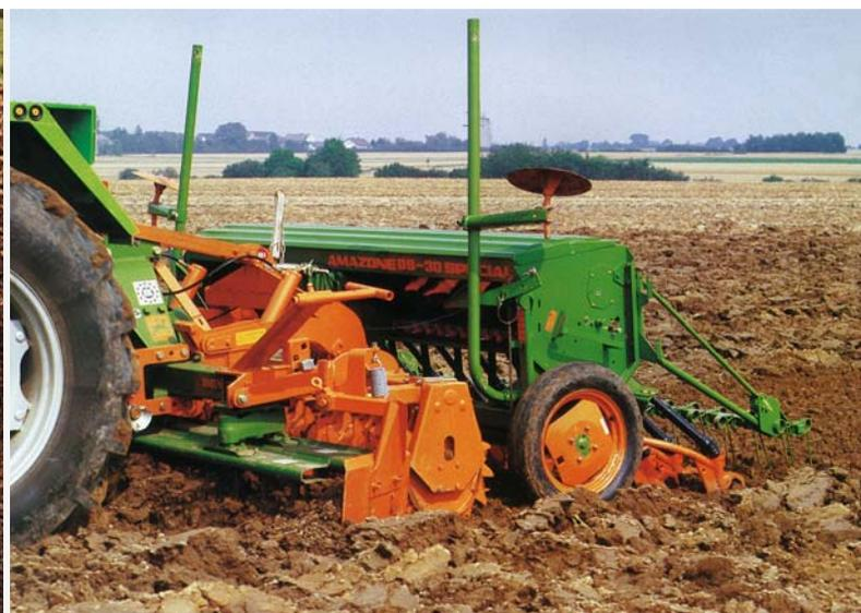
1985: Anbausämaschine D8-30 Special mit Rüttelegge RE und Federstahlzinkenbalken
