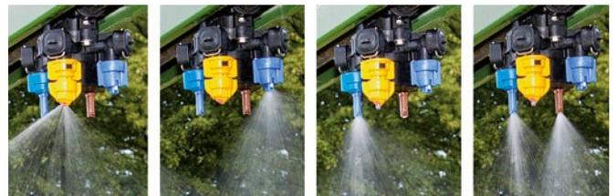
Ausgestattet mit 4 verschiedenen Düsentypen kann damit auch die Spritzmenge den Erfordernissen bei unterschiedlichen Fahrgeschwindigkeiten angepasst werden.
