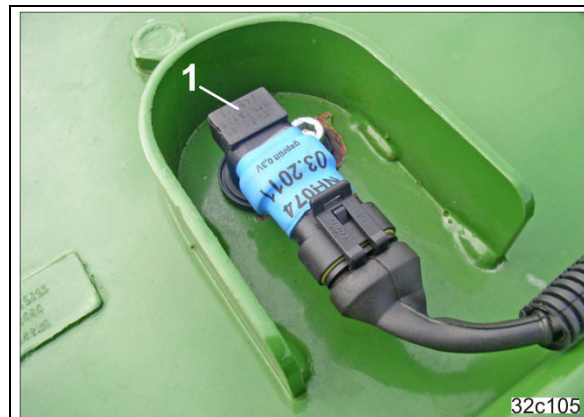
Hall-Sensor (1) am Winkelgetriebe
