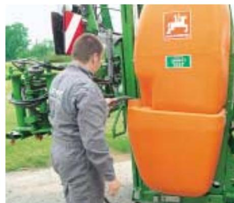
Der Reinwasserbehälter fasst 180 Liter und ist einfach zu befüllen.
