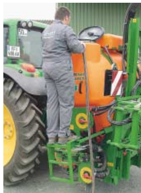
Die ausziehbare Leiter bietet einen sicheren Standplatz zum Befüllen über die Faßöffnung.
