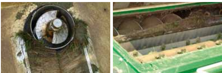
Eines der wichtigsten Merkmale beim Profihopper ist die Schneckenförderung. Re. als Querförderer im Mähwerk, li. vom Mähwerk zum Sammelbehälter.
