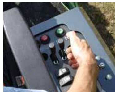
Der Profihopper ist ausgesprochen einfach zu bedienen. Selbst ungeübte Fahrer dürften kaum Probleme haben. Dazu trägt unter anderem bei, dass bei diesem Modell nun die Lenkhebel durch ein Lenkrad ersetzt wurden. Li.: Die Aushebung des Mähwerks funktioniert hydraulisch.
