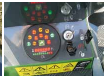
Der Profihopper ist ausgesprochen einfach zu bedienen. Selbst ungeübte Fahrer dürften kaum Probleme haben. Dazu trägt unter anderem bei, dass bei diesem Modell nun die Lenkhebel durch ein Lenkrad ersetzt wurden. Li.: Die Aushebung des Mähwerks funktioniert hydraulisch.
