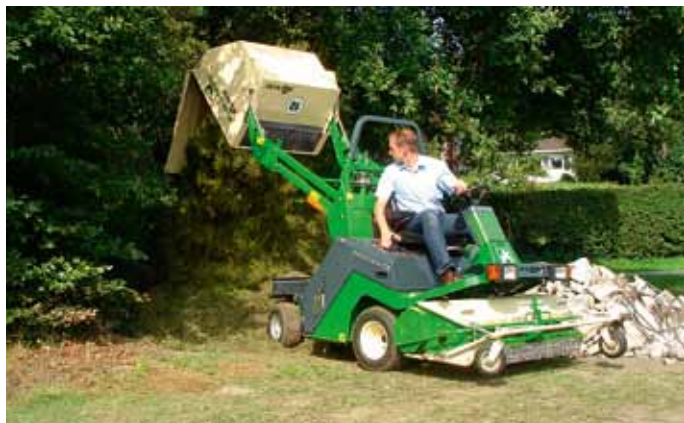
Durch die Überladehöhe von 2,10 Meter kann sogar auf einen Lkw abgekippt werden.
