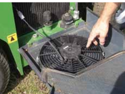
In periodischen Abständen reinigt sich der Kühler per Drehrichtungswechsel.
