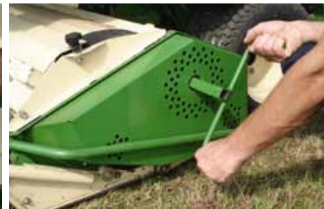
Eine Spindel mit Vierkant dient als Universalwerkzeug. Sie kann sowohl zur Höhenverstellung des Mähwerks (li.) als auch zum Reversieren verwendet werden.
