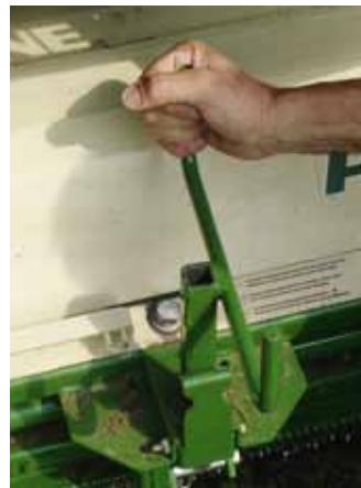
Eine Spindel mit Vierkant dient als Universalwerkzeug. Sie kann sowohl zur Höhenverstellung des Mähwerks (li.) als auch zum Reversieren verwendet werden.
