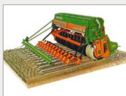
1988 Kreiselgrubber mit auf dem Reifenpacker aufgebauter Sämaschine AD
