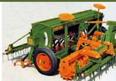
Rüttelegge RE mit Zahnpackerwalze und Anbausämaschine D7
