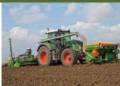
Fronttankkombi Avant mit klappbarem Kreiselgrubber für hohe Flächenleistung
