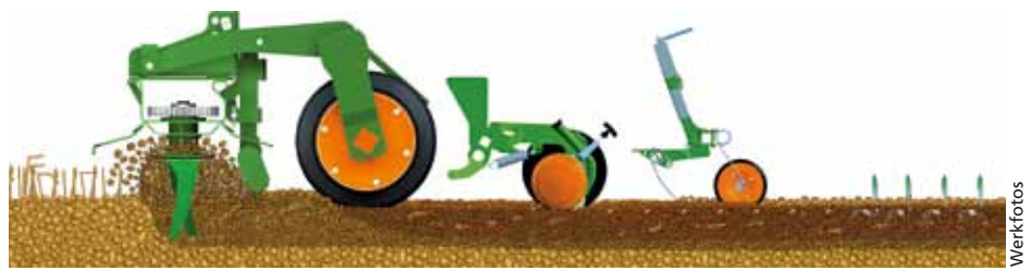
Saat in einem Arbeitsgang: Kreiselgrubber, Keilringwalze, RoTeC-Scheibenschar und Rollenstriegel.
