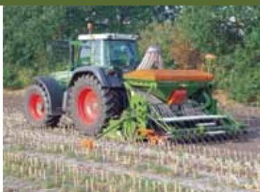
Pneumatische Sämaschine AD-P Profi mit großem Saattank
