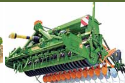
Keilringwalze, RoTeC-Schare und Exaktstriegel
