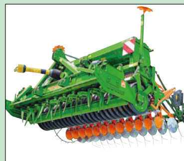
Keilringwalze und RoTeC-Schare bei der pneumatischen AD-P Profi.
