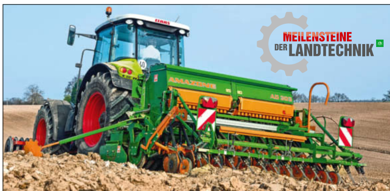
Die Bestellkombination AD 303 mit RoTeC-Rollscharen und Kreiselegge.
