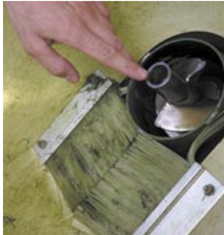
Ebenfalls neu: Das Endstück der Containerschnecke kann abgenommen und ggf. ersetzt werden.
