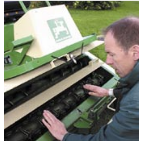
Gebietsverkaufsleiter Andreas Schreck demonstriert, wie einfach sich der Auffangmäher jetzt in einen Mulchmäher verwandeln lässt.
