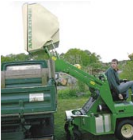
Die hydraulische Hochentleerung wurde auf 2,10 m erhöht. | Fotos: E. Bauer.
