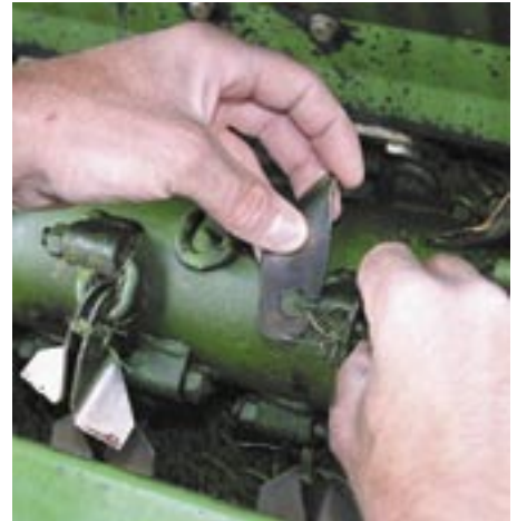
Die Messer lassen sich werkzeuglos wechseln: In Minuten wird so aus dem Mäher ein Vertikutierer.
