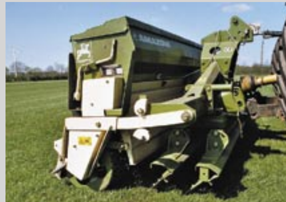
Nachsaat in einem Arbeitsgang: Die Zinkenbalken bewegen sich hin- und her, der Grassamen wird mit Erde gemischt und von der Gitterwalze angedrückt.
