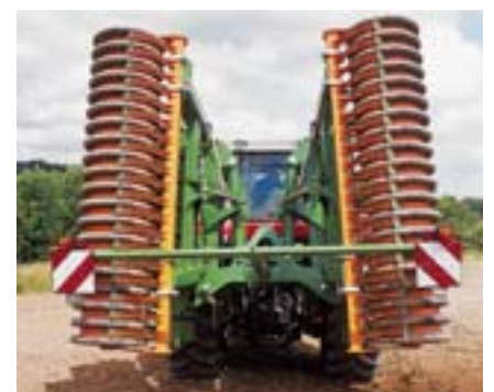
Eingeklappt ist der Catros 5001 295 cm breit und wiegt 3150 kg. Traktoren ab 140 PS mit Frontballast kommen damit zurecht.
