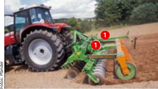
Neu: Über zwei Spindeln plus Ratsche (1) lässt sich jetzt die Tiefe verstellen. Auf Wunsch gibt es hydraulische Stellzylinder (750 €). Der Catros ist recht leichtzügig. Wir sind beim 5001 ab 140 PS zurechtgekommen. Ab 10 km/h ist das Arbeitsbild schön feinkrümelig.
