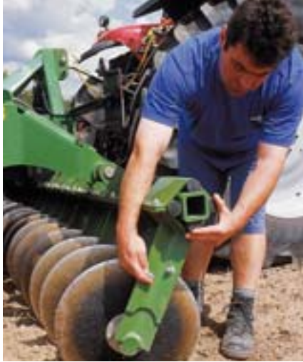
Neu: Über zwei Langlöcher lassen sich die äußeren Scheiben in der Höhe verstellen, um die Dammbildung zu reduzieren.
