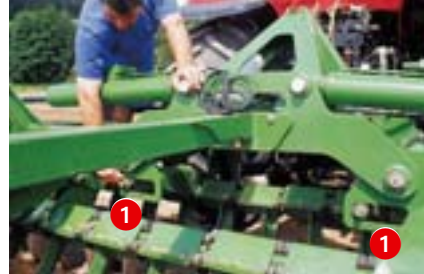
Neu: Über die Gummibuchsen (1) im Langloch stützt sich die vordere Scheibenreihe hinten ab. Das geringe Spiel sorgt für eine bessere Bodenanpassung.
