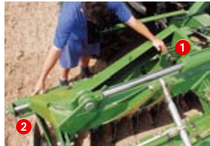
Neu: Je nach Position der Exzenter-Steckbolzen (1) verschiebt sich die vordere Scheibenreihe auf den kurzen Wellenstücken (2) um bis zu 200 mm.
