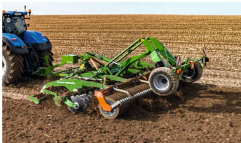
Catros XL 6003-2TS z przednim wałem nożowym
