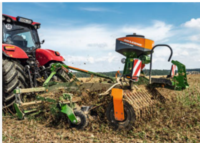
Catros XL 3003 z talerzem X-Cutter, wałem nożowym i siewnikiem GreenDrill
