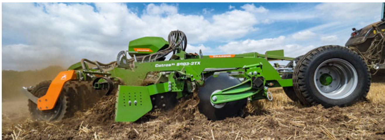
Catros XL 8003-2TX z kołami podporowymi
