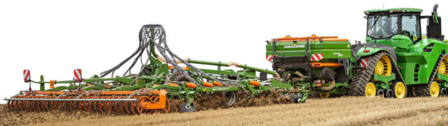
Zawieszany zbiornik XTender 4200 o pojemności 4200 l z agregatem Ceus 7000-2TX
