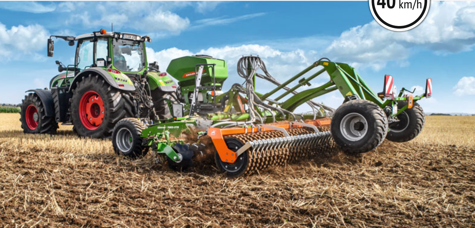
Catros+ 7003-2TS przy zrywaniu ścierniska
