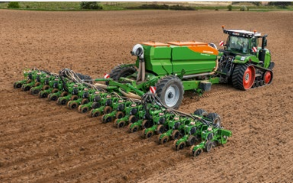
Precea 12000-TCC o szerokości roboczej 12 m i 16 rzędami
