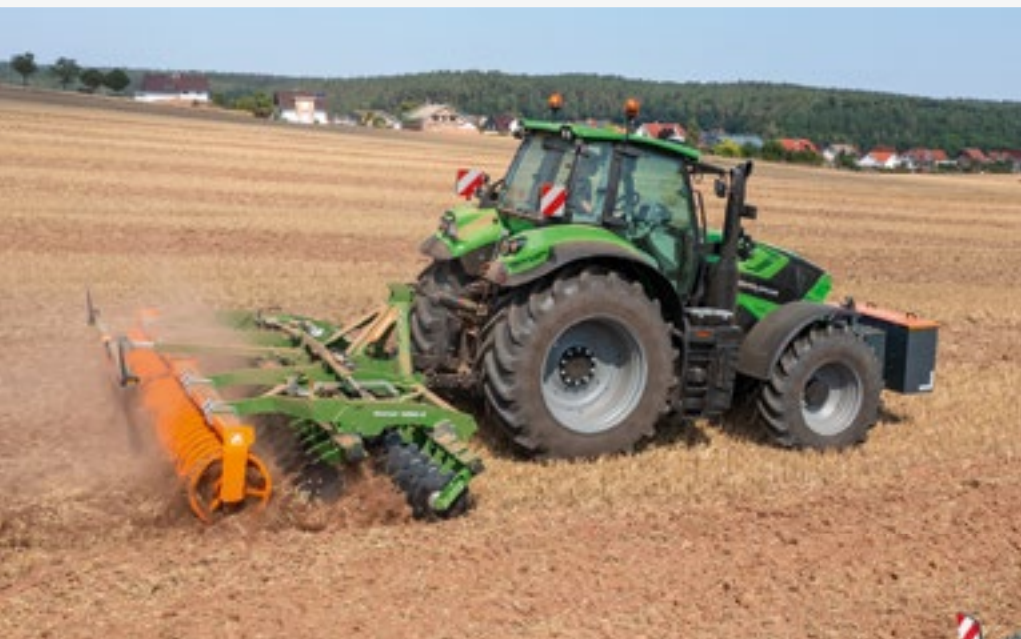
Brona Catros + 5003-2 wyposażona w zębate talerze, o szerokości roboczej 5 m
