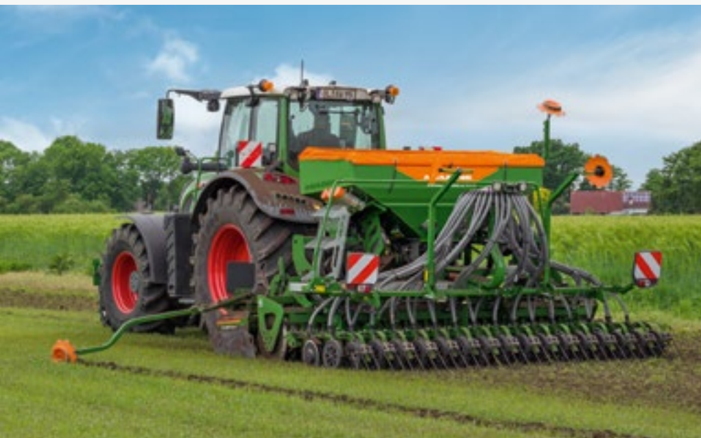
Centaya 4000-C Special z dwukomorowym zbiornikiem
