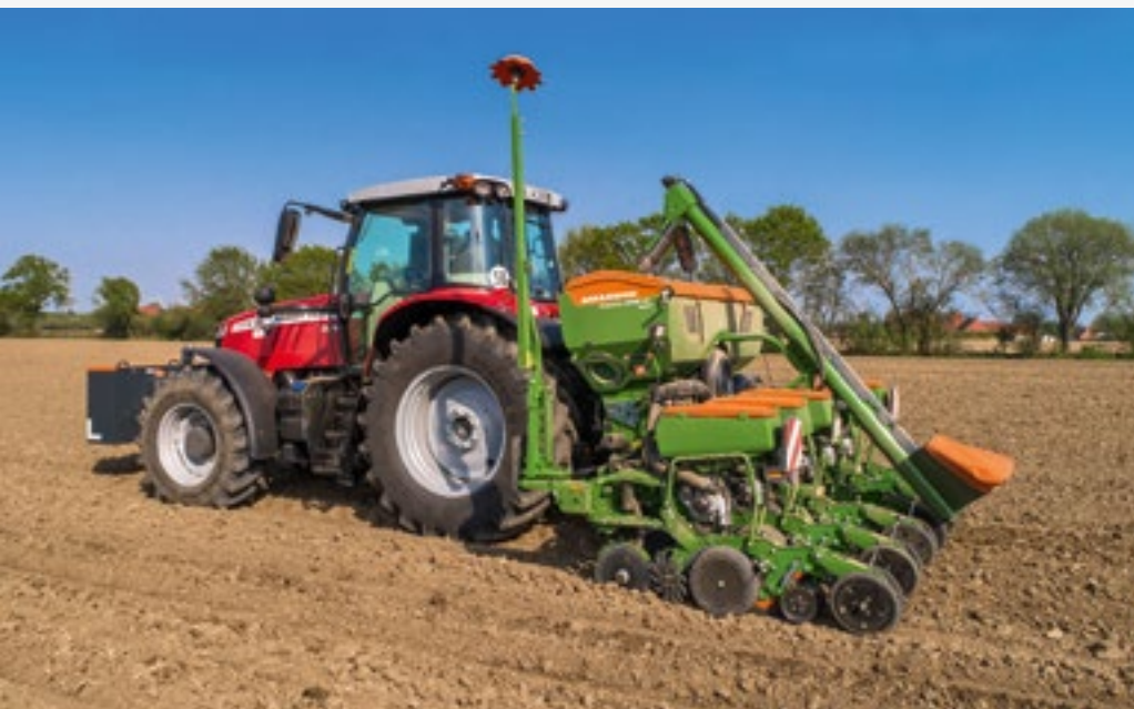
Nabudowany siewnik punktowy Precea 4500-2CC, 6-rzędowy
