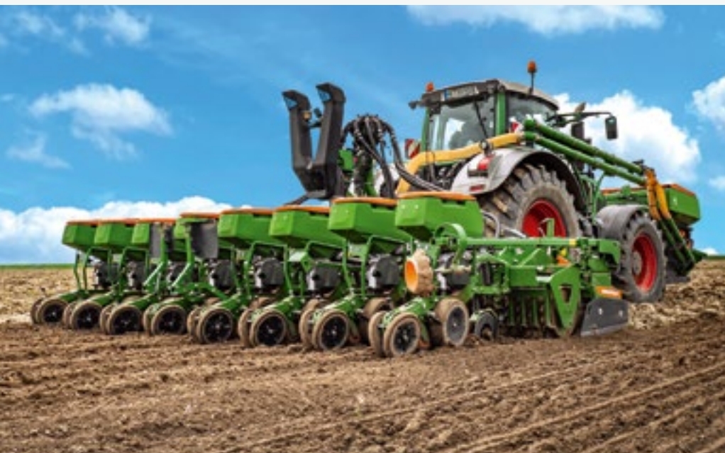
Siewnik punktowy Precea 6000-2AFCC z kultywatorem wirnikowym 6002-2 Super
