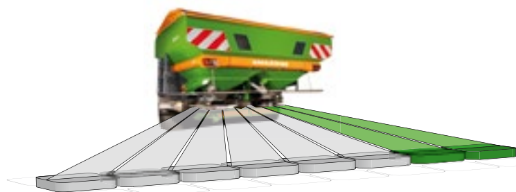
Przy włączeniu 8 lub 16 sekcji szerokości można w ZA-V rozsiewać sekcjami szerokości leżącymi na zewnątrz
