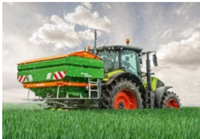
Rozsiewacz zawieszany ZA-TS z systemem WindControl – eliminacja wpływu wiatru na naciśnięciem przycisku
