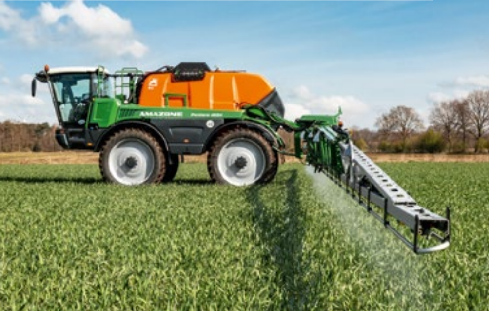
Opryskiwacz samojezdny Pantera 4504 z prześwitem 1,2 m
