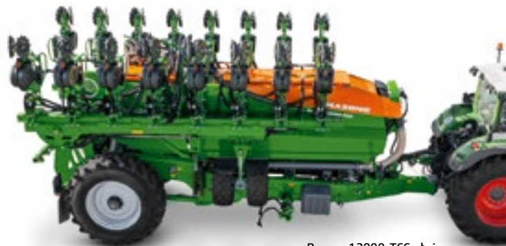
Precea 12000-TCC złożona do transportu do szerokości 3 m
