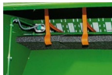
Opcjonalna przegroda do rzepaku redukuje pojemność zbiornika i zmniejsza ilości resztek nasion rzepaku.
