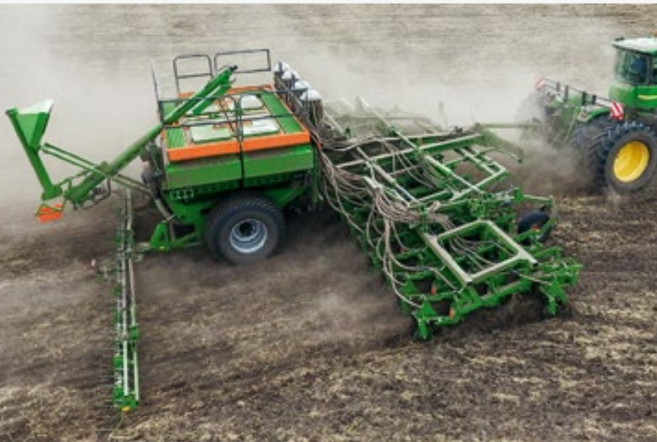
Primera DMC 12001-2C o szerokości roboczej 12 m z zewnętrznymi głowicami rozdzielającymi
