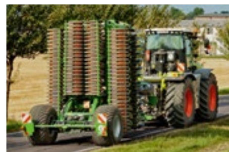
Bezpieczny transport po drogach z zachowaniem szerokości transportowej mniejszej niż 3 m, dzięki składanej hydraulicznie ramie maszyny.
