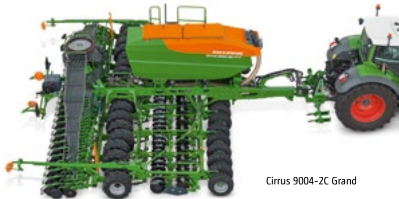
Cirrus 9004-2C Grand wyposażony w opony Matrix do zagęszczania pasmowego.
