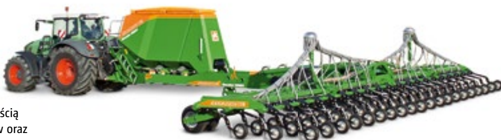
Condor 15001-C: szeroki na polu, wąski na drodze -tylko 3 m szerokości transportowej
