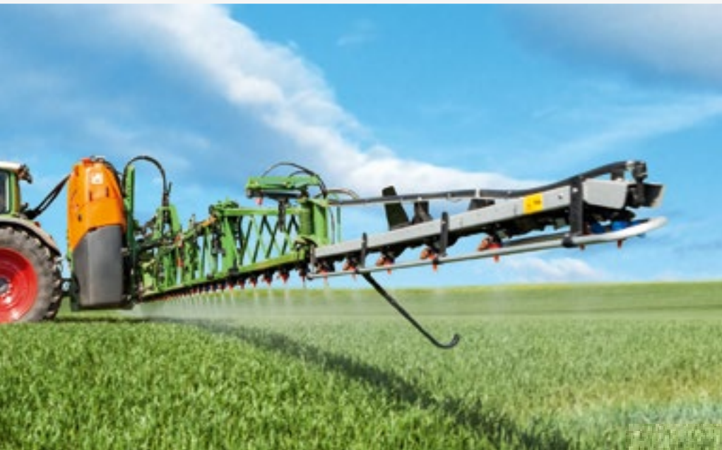
Opryskiwacz zawieszany UF 2002 z belką polową Super-S2 o szerokości 30 m
