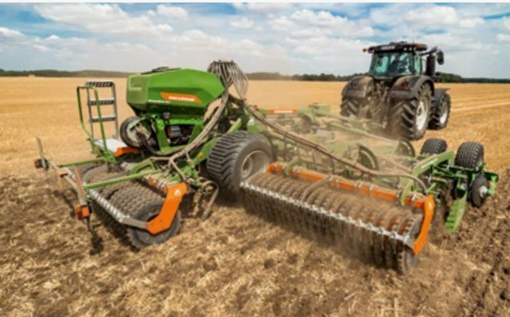
Kompaktowa brona talerzowa Catros XL 8003-2TX z uniwersalnym siewnikiem nabudowanym GreenDrill 501
