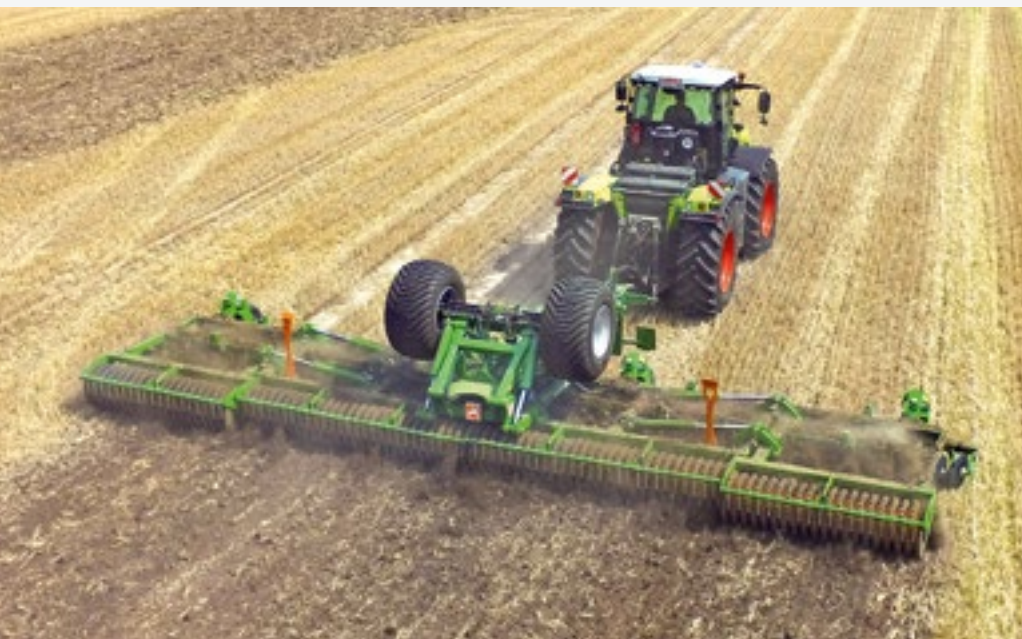
Catros + 12003-2TS o szerokości roboczej 12 m podczas uprawy ścierniska
