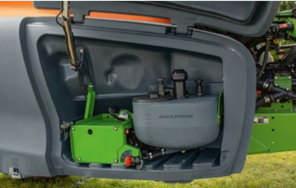
Wyposażenie DirectInject ze zbiornikiem 50 l i pompą w schowku UX 01 Super
