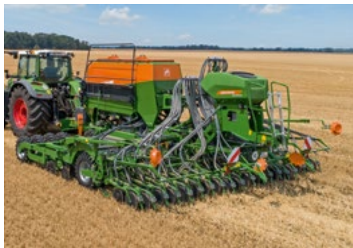
Cirrus 6003-2CC z talerzami Minimum TillDisc – zminimalizowana uprawa gleby oszczędzająca zasoby wodne
