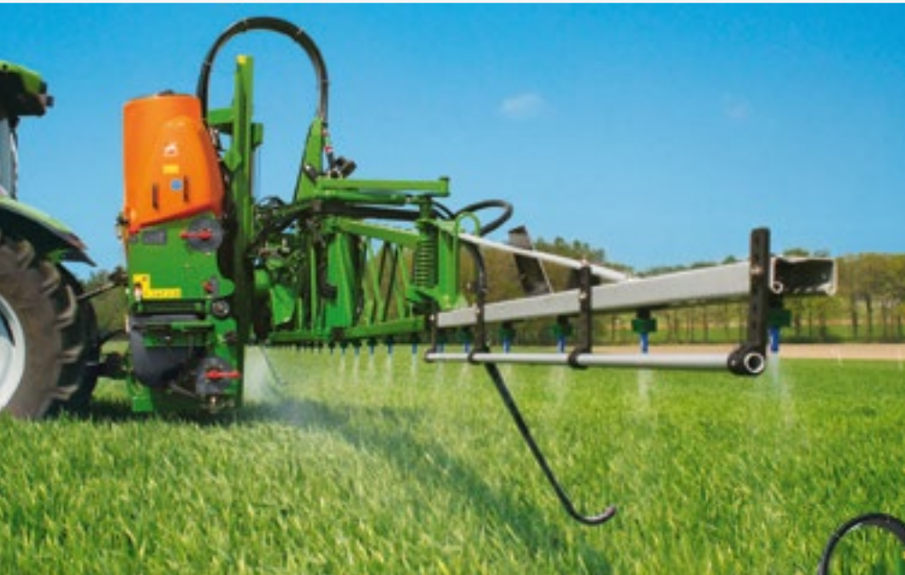
Opryskiwacz zawieszany UF 1201 z belką polową Super-S2 o szerokości 18 m
