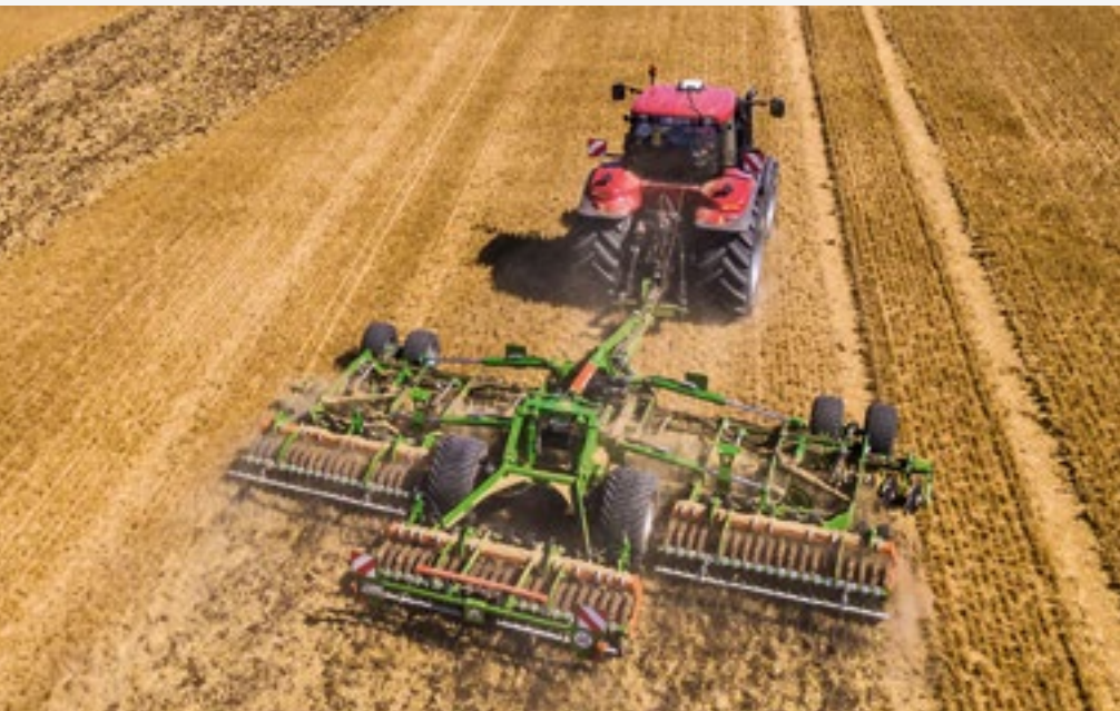
Catros + 8003-2TX z klinowym wałem pierścieniowym o profilu Matrix i szerokości roboczej 8 m
