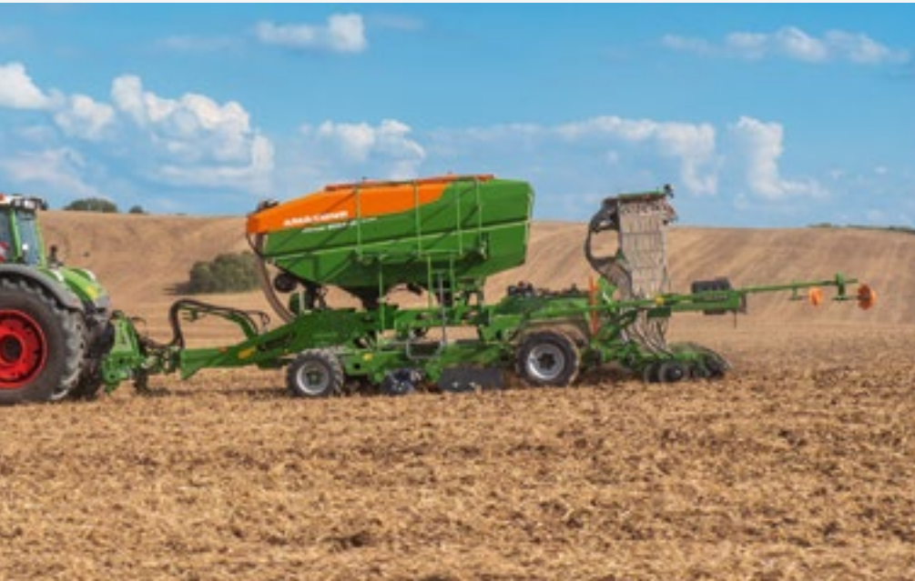
Cirrus 9004-2C Grand wyposażony w opony Matrix do zagęszczania pasmowego.
