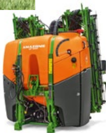
Opryskiwacz zawieszany UF 1602 z belką polową Super-S2 o szerokości 28 m
