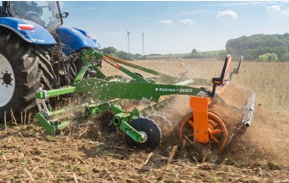
Catros + 3003 z ząbkowanymi talerzami o szerokości roboczej 3 m
