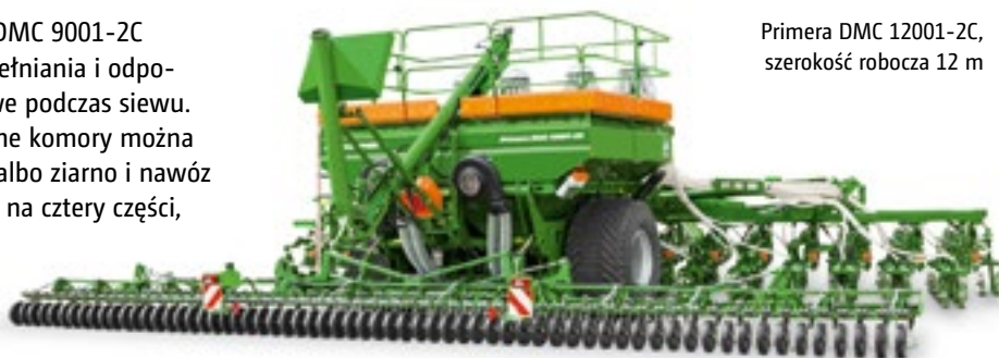
Primera DMC 12001-2C o szerokości roboczej 12 m z zewnętrznymi głowicami rozdzielającymi
