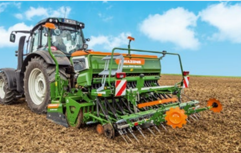
Maszyna Cataya 3000 Special wyposażona w redlice RoTeC i zagarniacz sprężynowy
