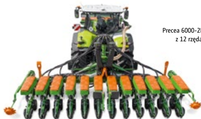
Siewnik punktowy Precea 6000-2AFCC z kultywatorem wirnikowym 6002-2 Super
