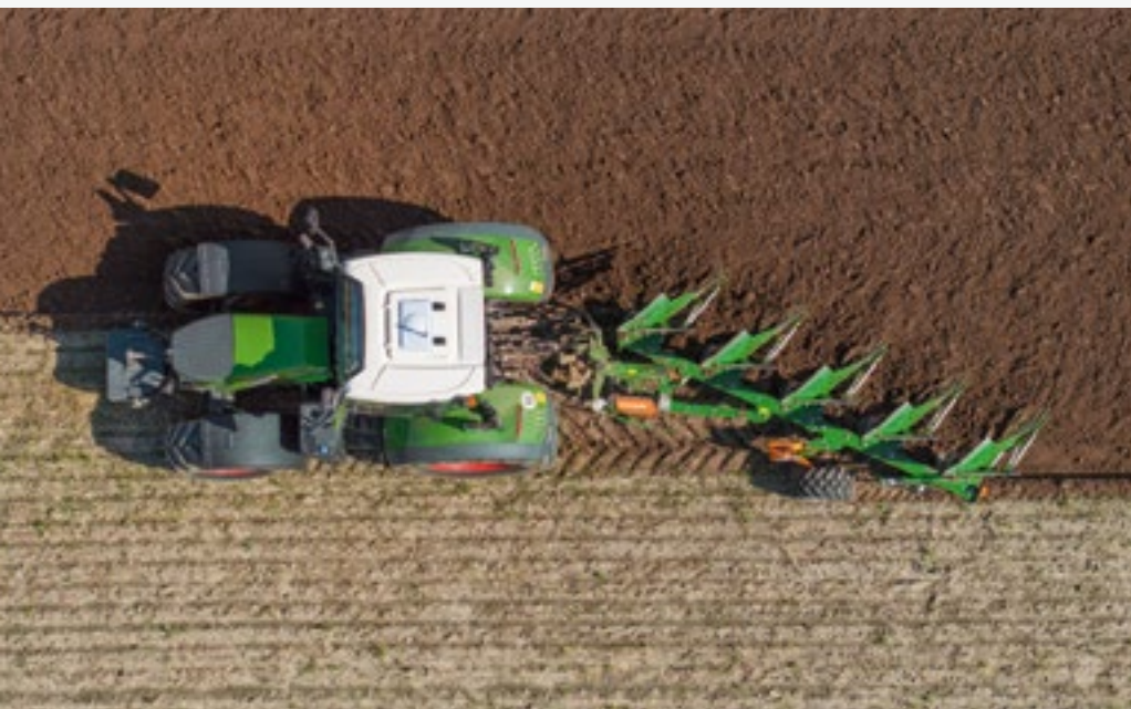
Pług z mechaniczną regulacją szerokości Teres 300, 5-skibowy
