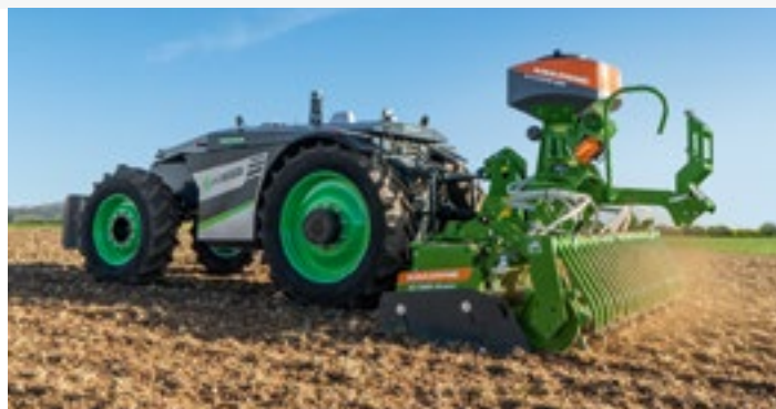
4-kołowy AgXeed AgBot i brona wirnikowa AMAZONE KE 3001 Super z siewnikiem nabudowanym GreenDrill
