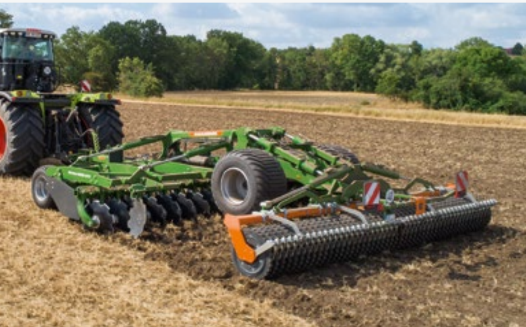
Certos 6002-2TX o szerokości roboczej 6 m z podwoziem środkowym TX
