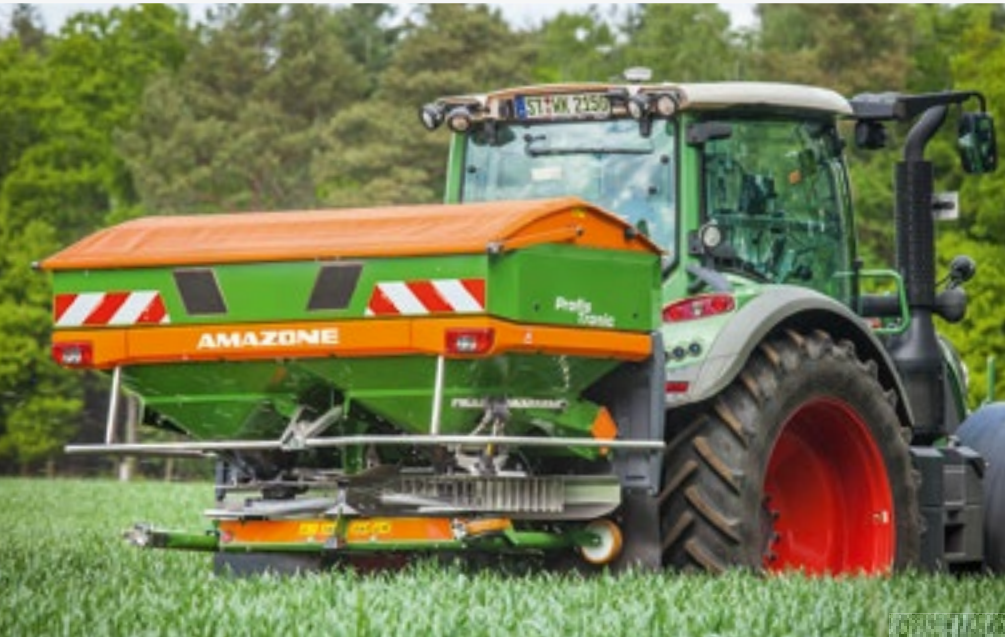
Rozsiewacz ZA-V 2000 Profis Tronic z układem ważenia i Limiterem V +
