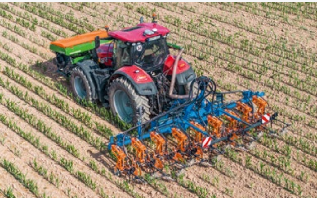
Venterra 2K w połączeniu z przednim zbiornikiem Ftender do nawożenia pasmowego
