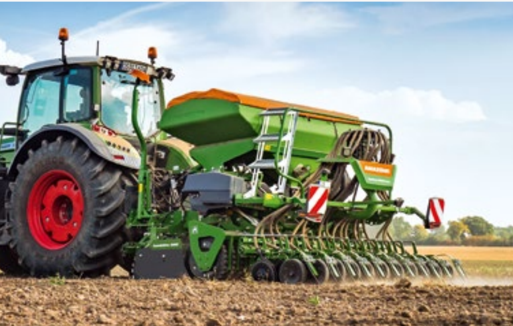
Siewnik Centaya 3000 Super wyposażona w redlice dwutalerzowe TwinTeC
