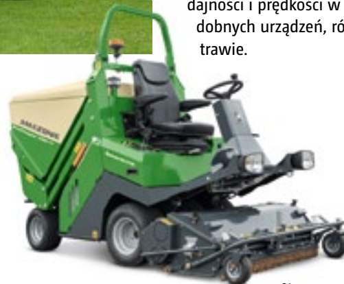
Profihopper 4WDi SmartLine z napędem przednich kół i zerowym promieniem skrętu
