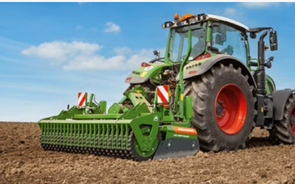
Kultywator wirnikowy KG 3001 z wałem pierścieniowym o profilu Matrix
