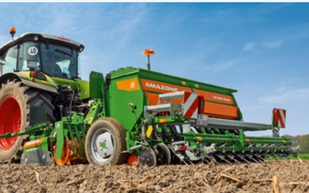
D9 3000 Super z zagarniaczem sprężynowym dokładnym, w kombinacji z broną wirnikową i zębatym wałem zagęszczającym
