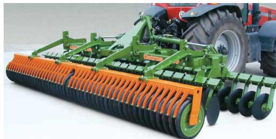
Mit ihr wird auch die Bearbeitungstiefe reguliert. Die Arme, an denen die Eggscheiben befestigt sind, werden in Gummi gelagert. Damit ist das Gerät stoßgesichert und gegen Bruch geschützt und passt sich der Bodenoberfläche an.
