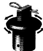
Partie inférieure de la tête d'agitateur avec goupille bêta
