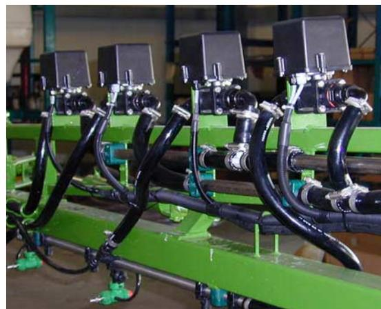
Abb. 28 Teilbreitenventile Variante „AIR“
