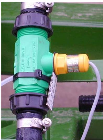
**Abb. 71** Anschluss Durchflussmesser 18-36 m
