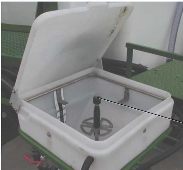
Die Einspülvorrichtung (Abb. 16) ist vorn links an der Maschine befestigt. Durch diese können Pflanzenschutzmittel in jeder Konfektionierung (Flüssigkeiten, Pulver, Pasten, u.w.) während des Füllvorganges in den Behälter gefördert werden. Weiterhin besteht die Möglichkeit, die Verpackungen der Pflanzenschutzmittel mit Hilfe einer Kanisterspüldüse (1) und eines Spannrahmens zu reinigen. Damit ist die berührungslose Zuführung der Pflanzenschutzmittel gewährleistet.
