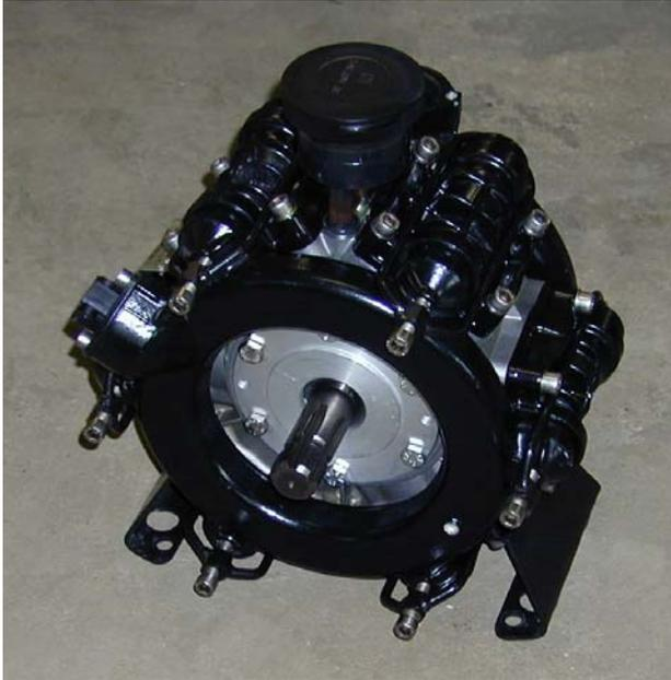
Die Drehzahl der Pumpe darf 540 U/min nicht überschreiten. Um die Leistungsfähigkeit der Pumpe während der Arbeit zu gewährleisten, ist es notwendig, nach 300 Betriebsstunden - spätestens jedoch am Ende der Saison -, die Membran zu überprüfen und unabhängig von deren Zustand zu ersetzen. Defekte Membranen führen zum Eindringen der Spritzbrühe in den Antriebsteil, was die Zerstörung der Pumpe nach sich ziehen kann.
