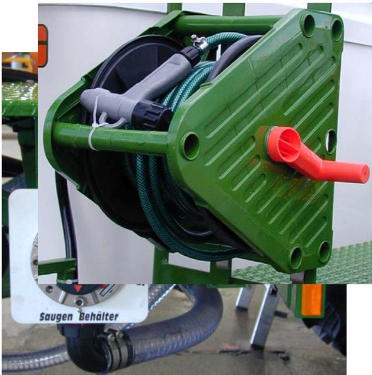
Abb. 17 Spritzpistole mit Schlauchtrommel
