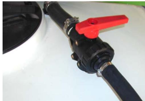
Abb. 53 Befüllen des Frischwasserbehälters
