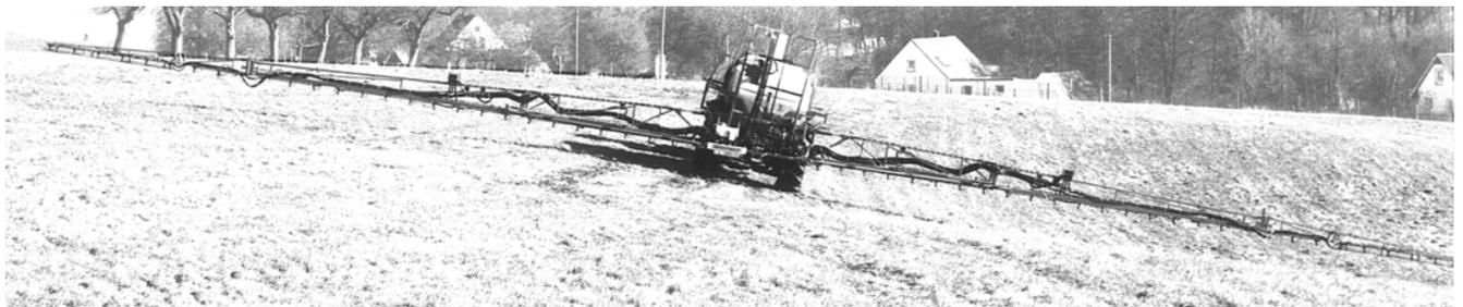
Abb. 46 Einsatz der Feldspritze in Hanglagen mit verstelltem Pendelausgleich.
