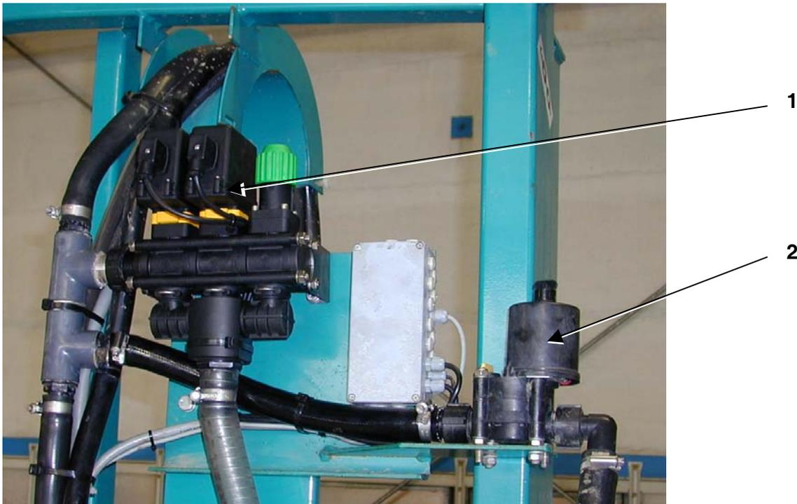
Abb. 20 Druckregler (1) und Hauptventil (2)
