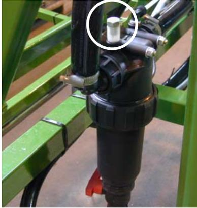
**Abb. 69** Prüfanschluss für Manometer am Druckfilter
