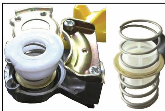
**!** O-Ring korrekt auf dem Kunststoffring positionieren.
