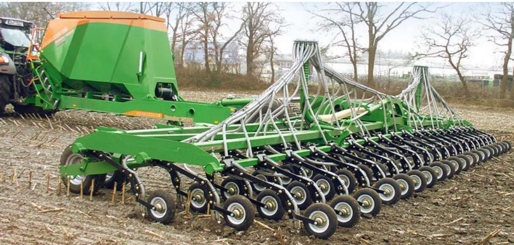
Der Kraftbedarf einer 12 m Condor beträgt nur 220 PS, die Fahrgeschwindigkeit ca. 10 km/h. Die Tagesleistung einer 15 m Condor bei einem 13 Stunden-Tag liegt bei bis zu 150 Hektar. Sie lässt sich für den Transport auf 3 m zusammenklappen. Inzwischen ist die Maschine auch weitgehend ausgereift und hat sich bestens bewährt.
