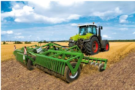
Als Ideallösung für die Stoppelbearbeitung bietet Amazone die Kompakt-Scheibenegge Catros mit Arbeitsbreiten von 3 bis 7,5 m an. Weil der Catros hohe Schlagkraft (ca. 1 Hektar pro Meter Arbeitsbreite)
