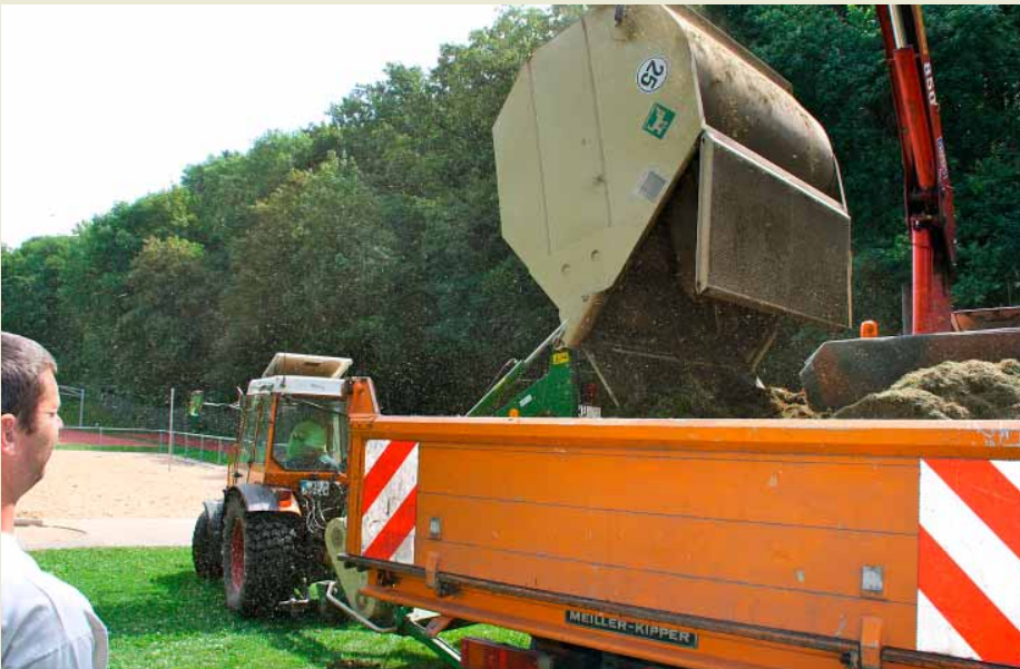
Dank Hochkippfunktion lässt sich der 3 cbm fassende Fangkorb bequem vom Fahrersitz aus entleeren.
