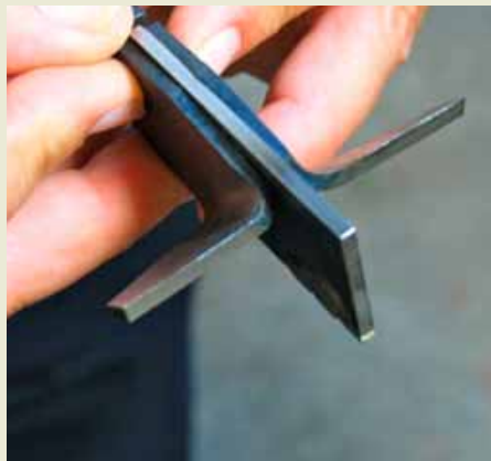
Diese Messer-Variante wird zum so genannten Kurzmähen und gleichzeitigen Vertikutieren eingesetzt.
