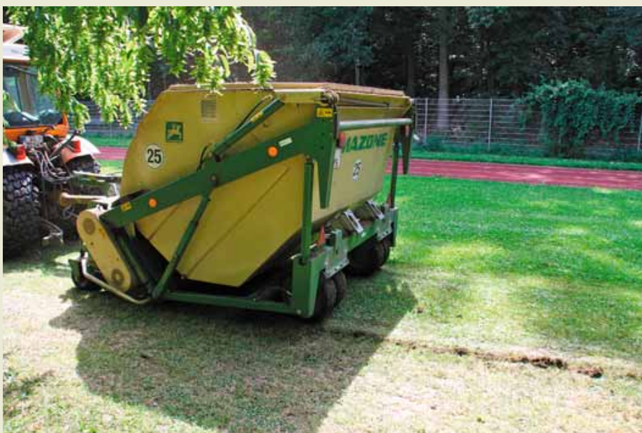
Nach der Überfahrt bleibt kein Material mehr liegen – die Sogwirkung der rotierenden Messer macht's möglich.
