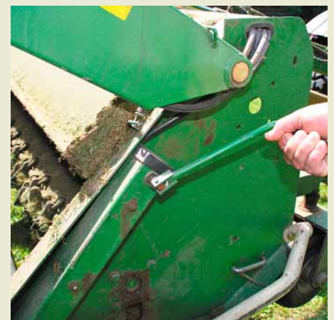
Die Schnitthöhe des Grasshopper Jumbo über die hintere Stützwalze lässt sich einfach mit einer Kurbel stufenlos einstellen.
