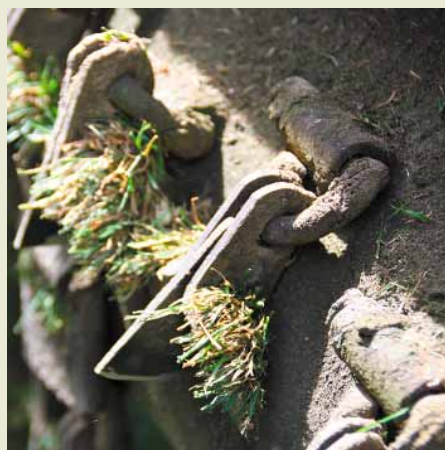
Die Vertikutier- und Flügelmesser am Rotor des Grasshoppers erzeugen bei der Mähgutaufnahme eine hohe Saugwirkung.
