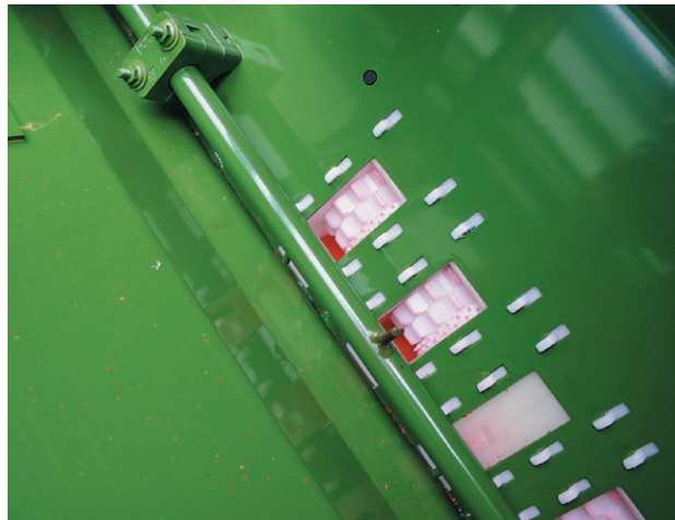
Afbeelding 2: Blik in de zaadgedvoorraadsreservoir met roeras, wielen voor normale en fijne zaden.
