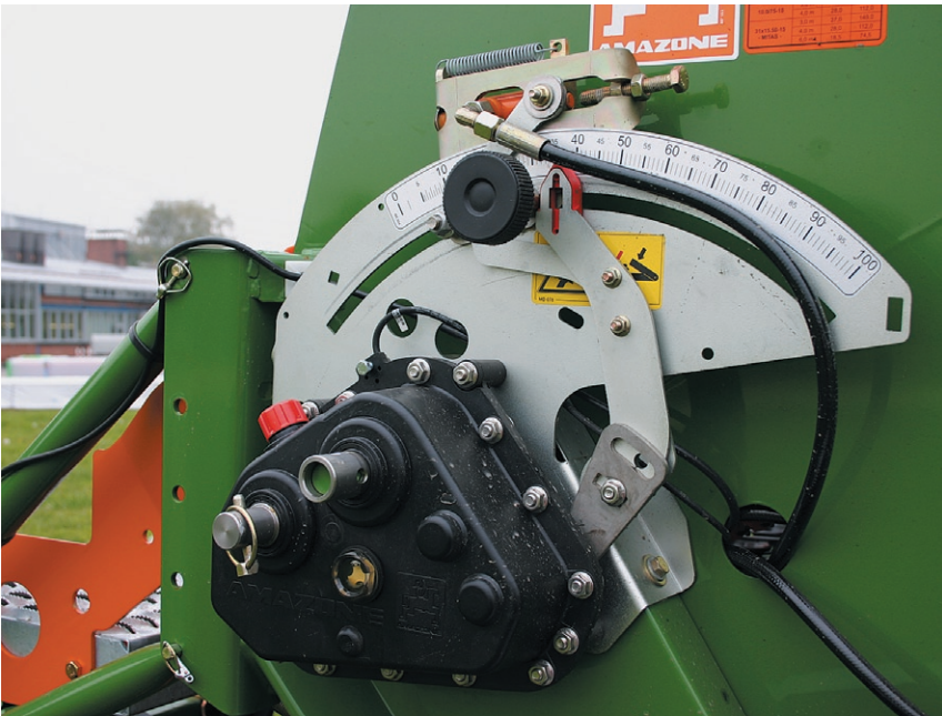
Figura 5: La regolazione della quantità di semente presso il riduttore avviene in continuo sul lato destro della macchina. Il numero di rotazioni della manovella necessarie per la calibratura è riportato in forma ben visibile su una targhetta adesiva posta sopra il riduttore. Il dispositivo idraulico in figura per la regolazione della quantità di semente è disponibile opzionalmente.
