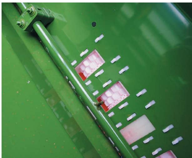
Figura 2: interno del serbatoio della semente con albero agitatore, ruote di semina normale e fine.
