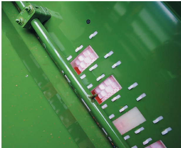
Schéma 2: Vue du réservoir de semences avec roues de distribution.
