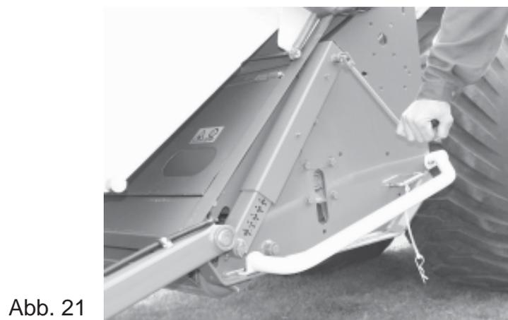
Durch Drehen im Uhrzeigersinn wird die Stützrolle eingefahren, die Arbeitshöhe somit verkleinert; durch Drehen gegen den Uhrzeigersinn wird die Stützrolle ausgefahren und die Arbeitshöhe vergrößert (siehe Abb. 22).
