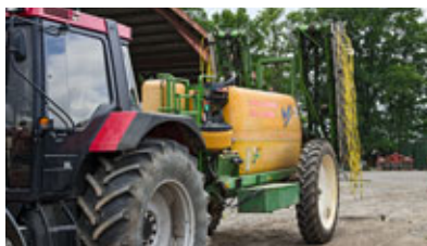
Eine UG 4500 wird im späteren Frühjahr mit einem Schleppschlauchverband für die AHL-Düngung in Getreide und Mais eingesetzt. Auch das funktionierte mit dem Super-S-Gestänge von Anfang an sehr gut.
