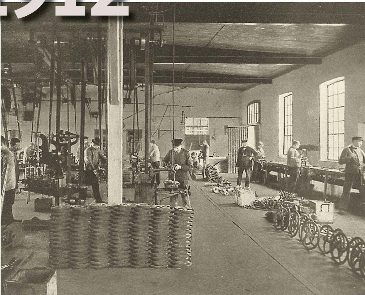
Drehbänke und Bohrmaschinen, angetrieben von Treibriemen der Transmissionswellen, 1912
