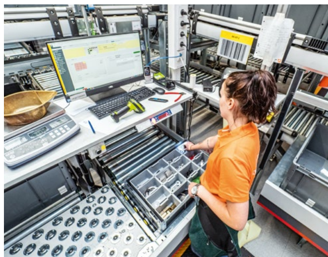
Arbeitsplatz am automatischen Kleinteilelager (AKL)
