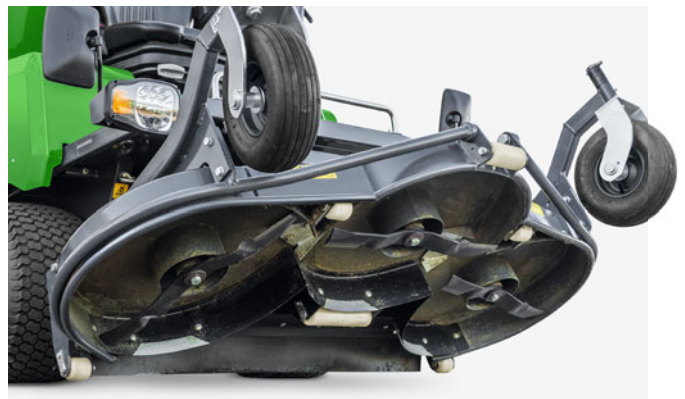
BladeCut-cirkelmaai dek met 3 rotormessen
