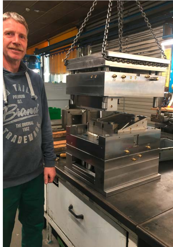
Outil d'injection plastique fabriqué dans notre atelier d'outillage
