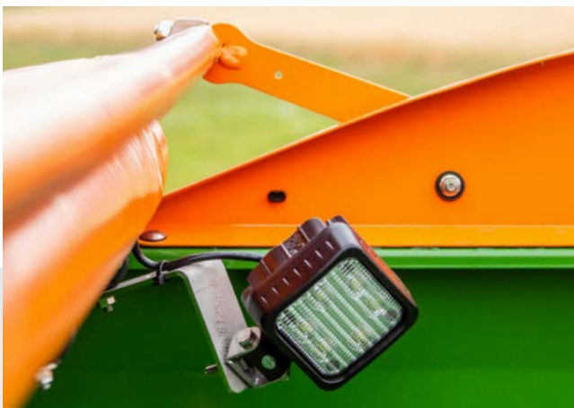
Vidinis bunkerio apšvietimas
