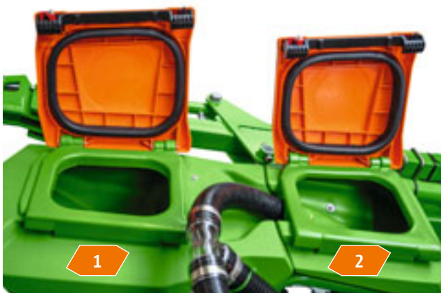
Extra trechters op elke rij voor 1) microgranulaat en 2) fijn zaad
