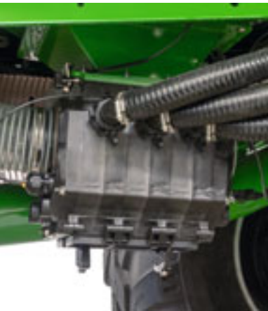
Sensoreenheid onder de centrale zaadtank
