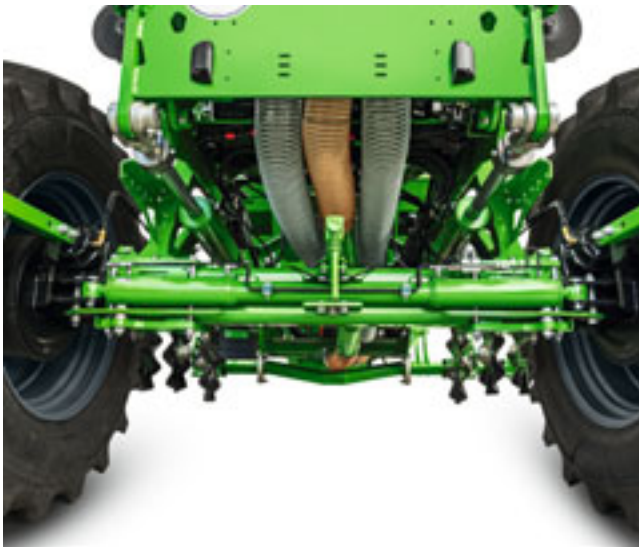
Hydraulische cilinders van de telescopische as
