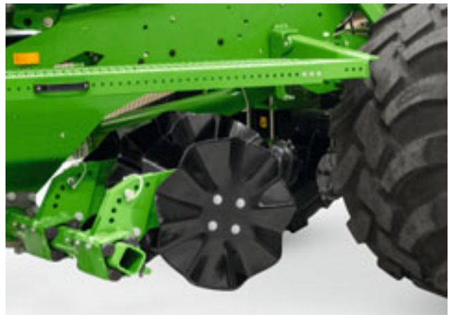
Mechanische hoogte-instelling van de sporenwissers van het gegolfde schijf wiel
