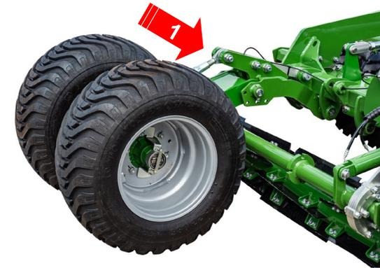
4. Mittelrahmen parallel zum Boden?
