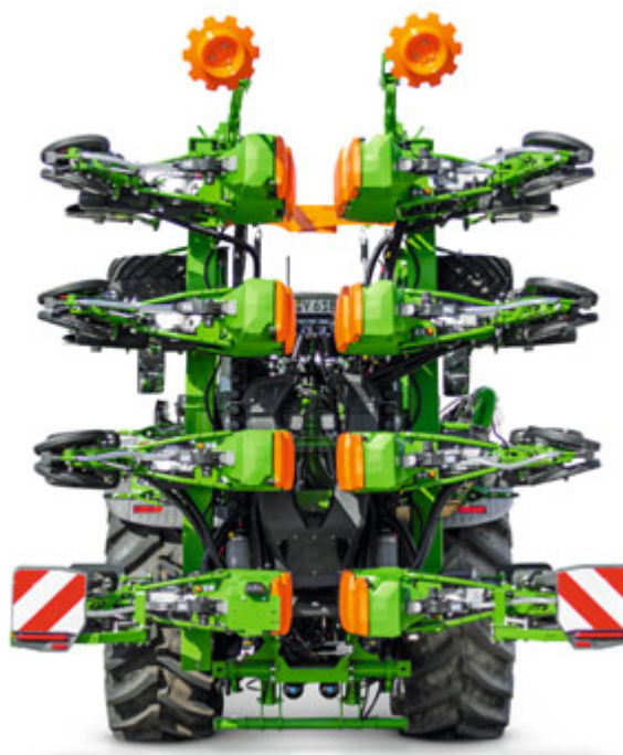
Precea 6000-2FCC met 9 rijen opgeklapt voor wegtransport
