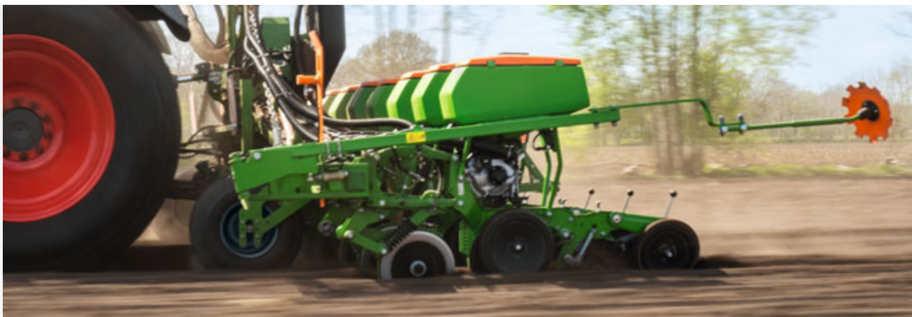
Precea 6000-2FCC met FerTeC Twin HD-kunstmestkouter
