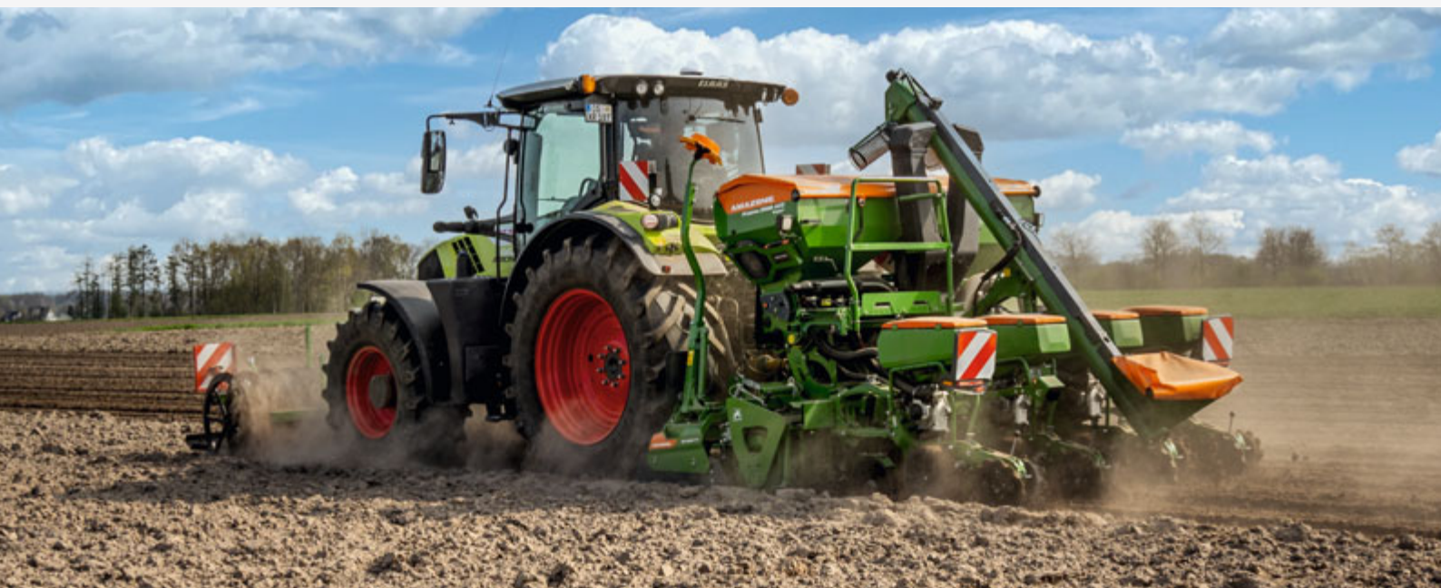
De Precea 3000-ACC met de KX rotorcultivator in actie
