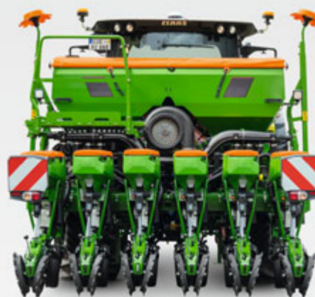
De Precea 4500-2CC met variabel telescopisch frame met de kleinste werkbreedte
