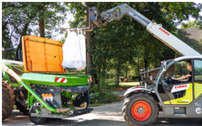
Grote trechteropening van 1,10 m x 2,20 m voor snel en eenvoudig vullen van de FTender
