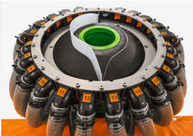
Segmentverdelerkop met geactiveerde halfzijdige schakeling
