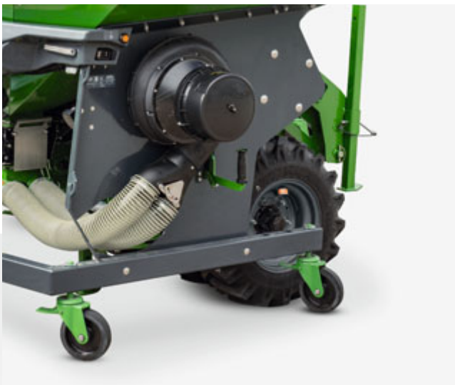
FTender met frontbandenpakker T-Pack F met optionele transportwielen en optionele stofafscheider
