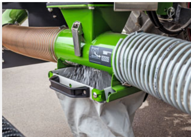
De kalibratiezak kan gemakkelijk onder de doseerunit worden opgehangen
