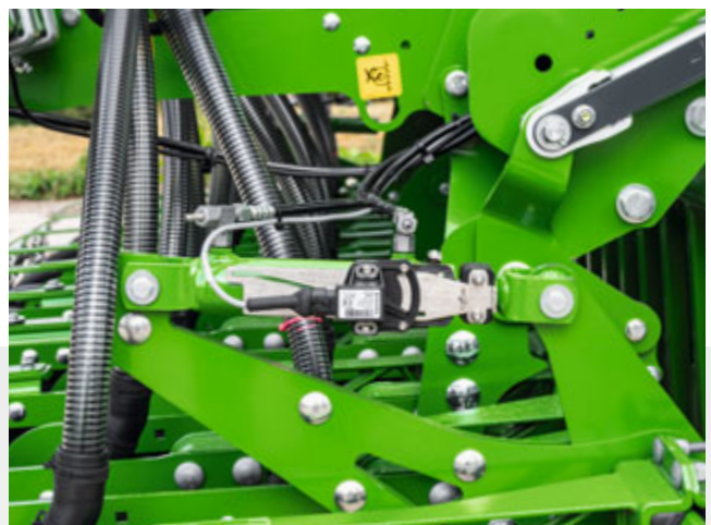
Cilinder voor de hydraulische kouterdrukverstelling
