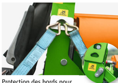
Protection des bords pour sécuriser les déplacements 1+2+4
