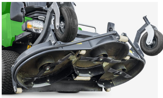
Unité de tonte à 3 lames rotatives BladeCut
