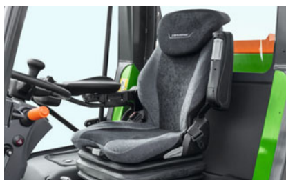
Différentes variantes de siège, par exemple le siège « De Luxe » Grammer chauffant avec suspension pneumatique
