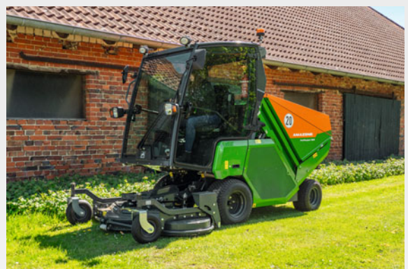
ProfiHopper 1500 Cab mit BladeCut-Sichelmähwerk
