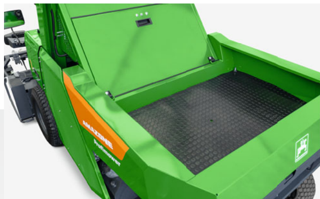
Pritsche des ProfiMower für das Mitführen von Arbeitsmaterialien
