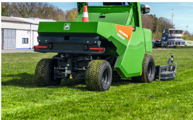
Das Mähgut verbleibt als fein gehäckselter Mulch auf der gemähten Fläche.
