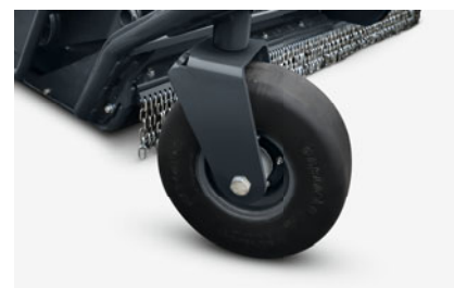
Die unplattbaren Reifen sorgen für mehr Einsatzsicherheit
