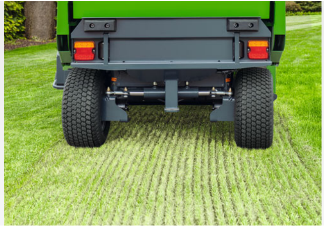
Mähen und Vertikutieren in einem Arbeitsschritt
