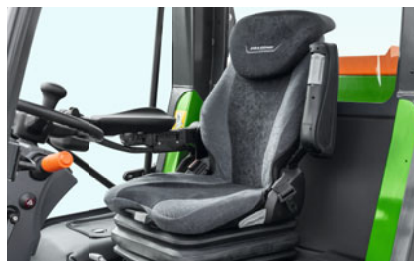
Unterschiedliche Sitzvarianten, zum Beispiel der Sitz „De Luxe“ Grammer mit Luftfederung und Heizung
