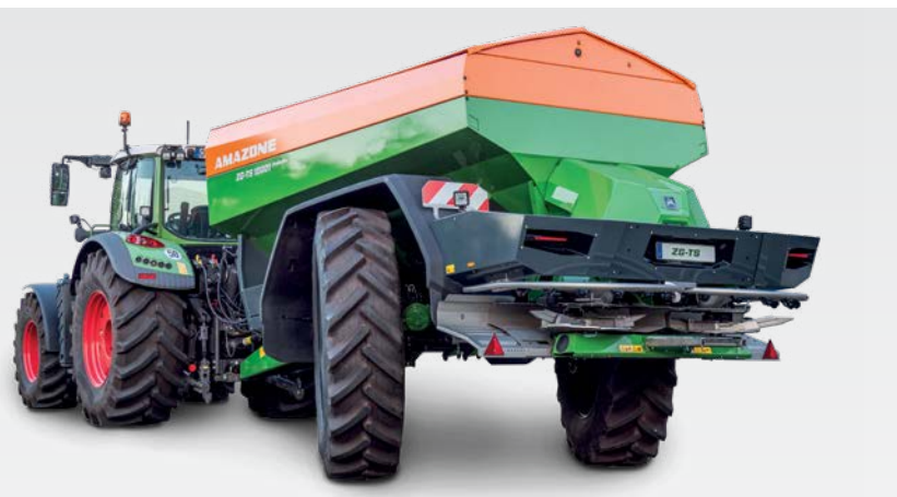
Gestuurde as met stuuruitslag tot 28 °
