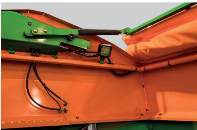
Werkverlichting voor de binnenkant van de voorraadtrechter
