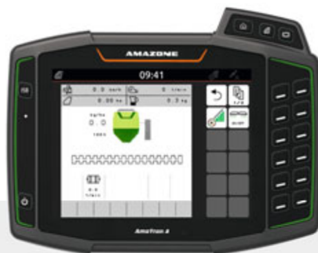
Удобное управление GreenDrill 501 и FTender с помощью ISOBUS-терминала управления
