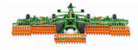
Прицепная компактная дисковая борона Catros Ширина захвата от 7 м до 12 м
