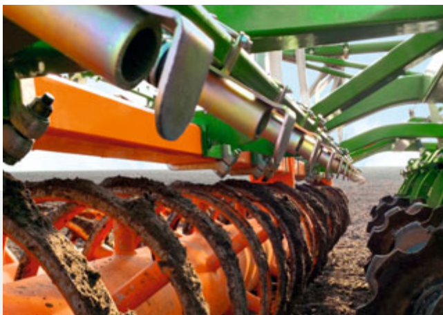
Отражатель семян для поверхностного внесения перед катком
