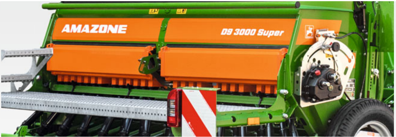
Zaadtank van de D9 met traploos verstelbare variotransmissie
