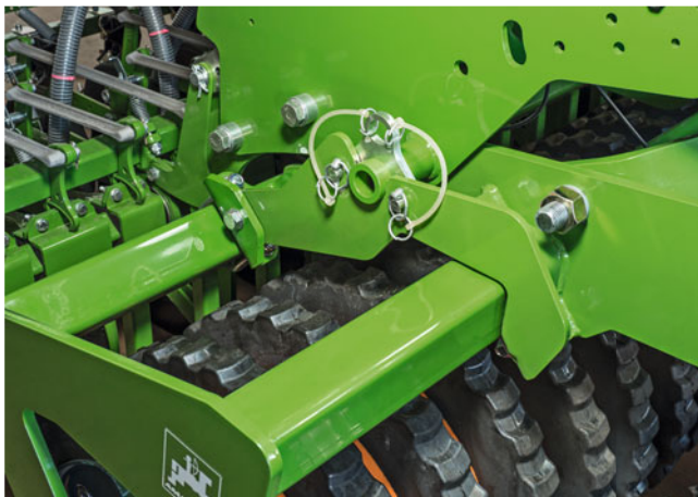
✔ Snelkoppelsysteem QuickLink – eenvoudiger, sneller en zonder gereedschap aan- en afkoppelen
