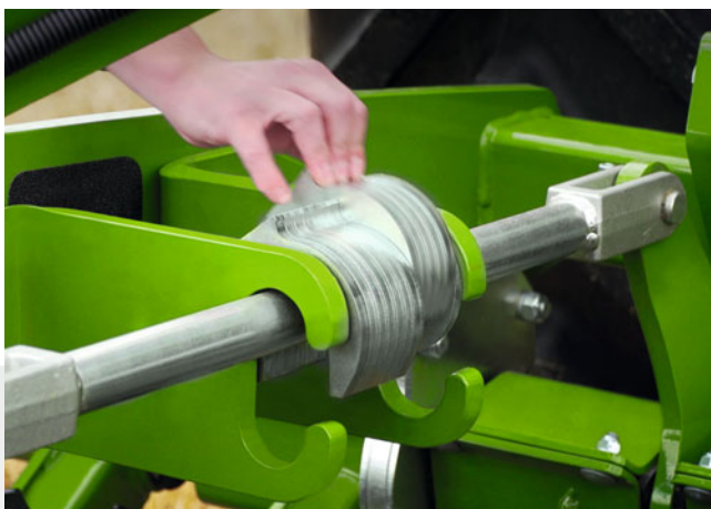
Werkdiepte-instelling met afstandsringen – vlakke werkdiepte
