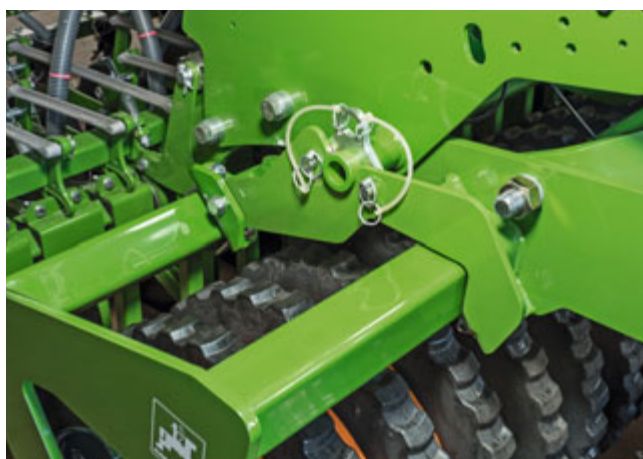
✔ Snelkoppelsysteem QuickLink – Eenvoudig, snel en gereedschapsloos aankoppelproces en afkoppelproces
