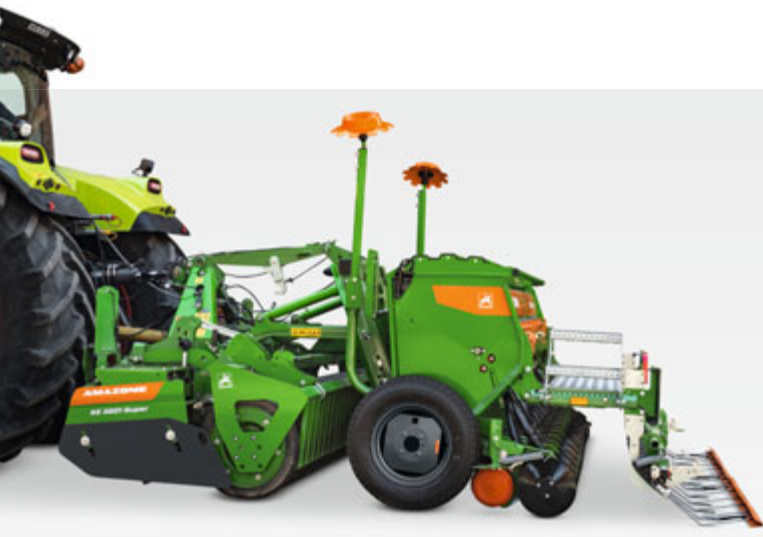
De rotorcultivator KG 3001 Super met Huckepack-systeem en aangekoppelde aanbouwzaamachine D9 3000
