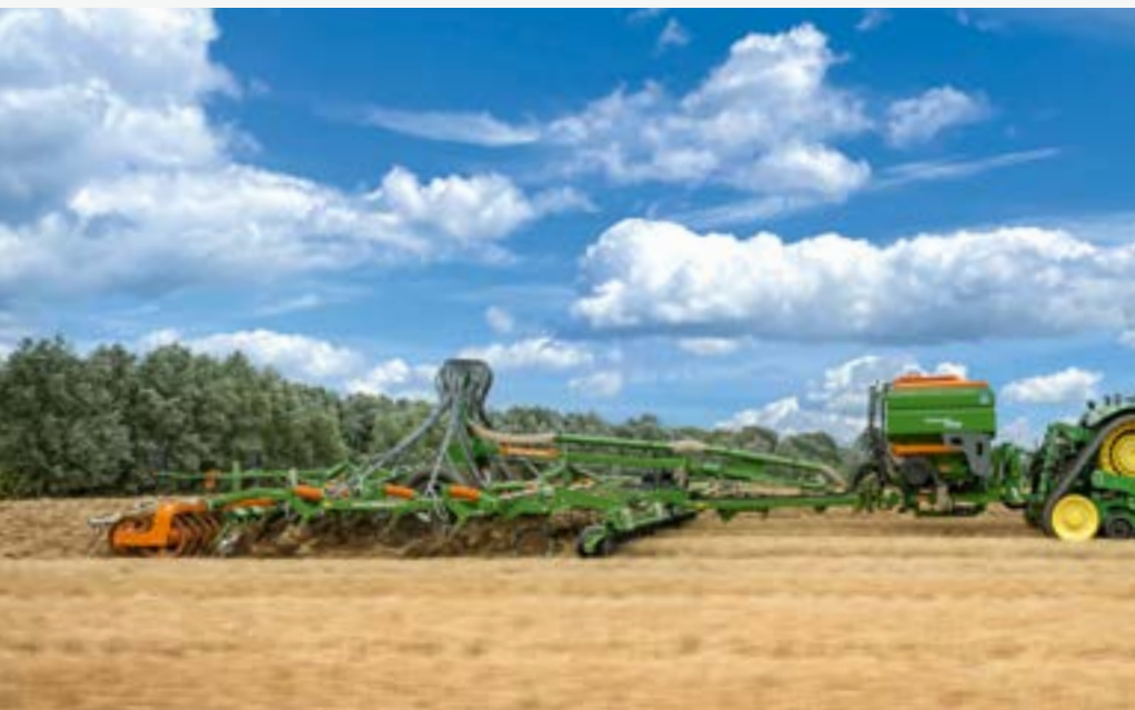
XTender 4200 mit Cenius 7003-2TX und zwei Förderstrecken zur Ausbringung von Dünger und Saatgut
