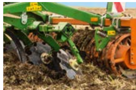
Gezackte Einebnungsscheibe 460 mm für den Einsatz auch mit hohen Stroh­mengen. Stärkerer Mischeffekt als bei glatten Scheiben, jederzeit sicherer Antrieb.
