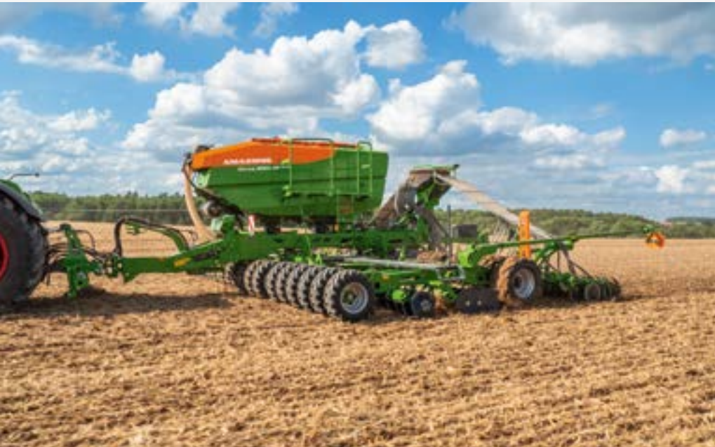
Cirrus 9004-2C Grand mit Spurlockerer im Zwischenanbau
