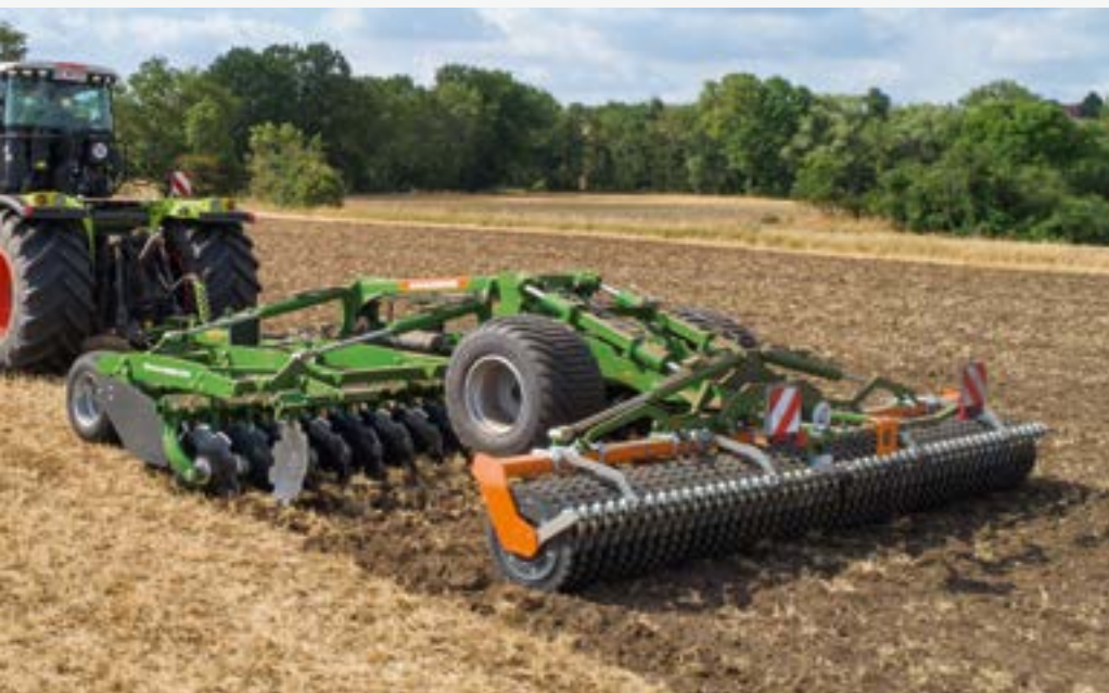
Certos 6002-2TX in 6 m Arbeitsbreite mit Mittelfahrwerk TX
