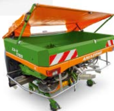
Zweischeibenstreuer ZA-V 1700 mit Abdeckschwenkpläne
