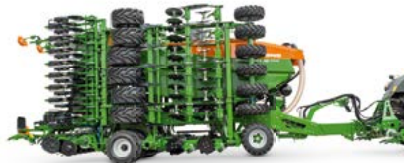
Cirrus 9004-2C Grand geklappt auf 3 m Transportbreite
