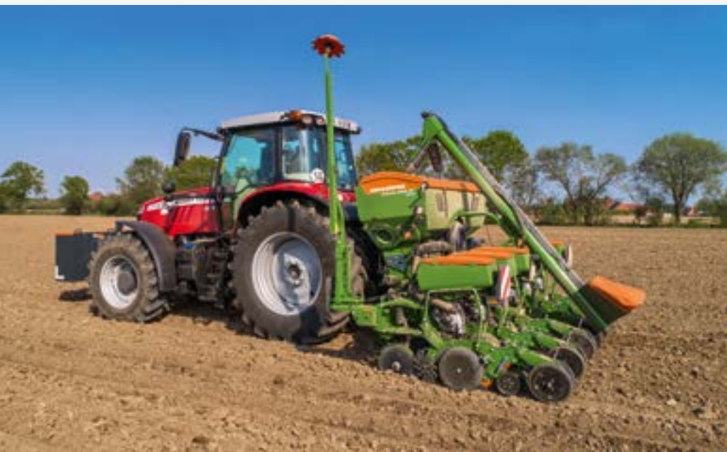
Aufgebaute Einzelkorn-Sämaschine Precea 4500-2CC, 6-reihig
