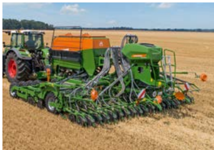
Cirrus 6003-2CC mit Minimum TillDisc-Scheiben – minimale und wassersparende Bodenbearbeitung
