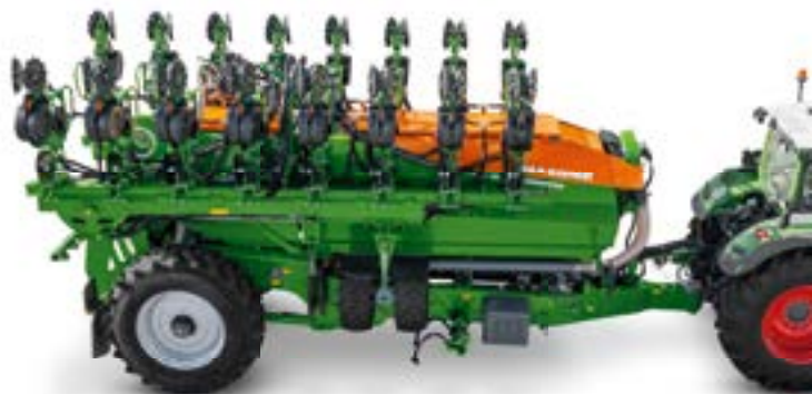
Precea 12000-TCC geklappt auf 3 m Transportbreite
