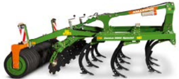
Cenius Special: Zinken mit Abschersicherung
