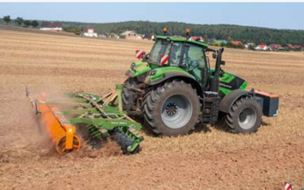
Catros + 5003-2 mit gezackten Scheiben und einer Arbeitsbreite von 5 m
