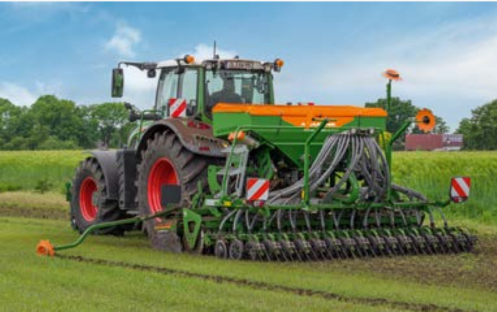
Centaya 4000-C Special mit Zweikammerbehälter
