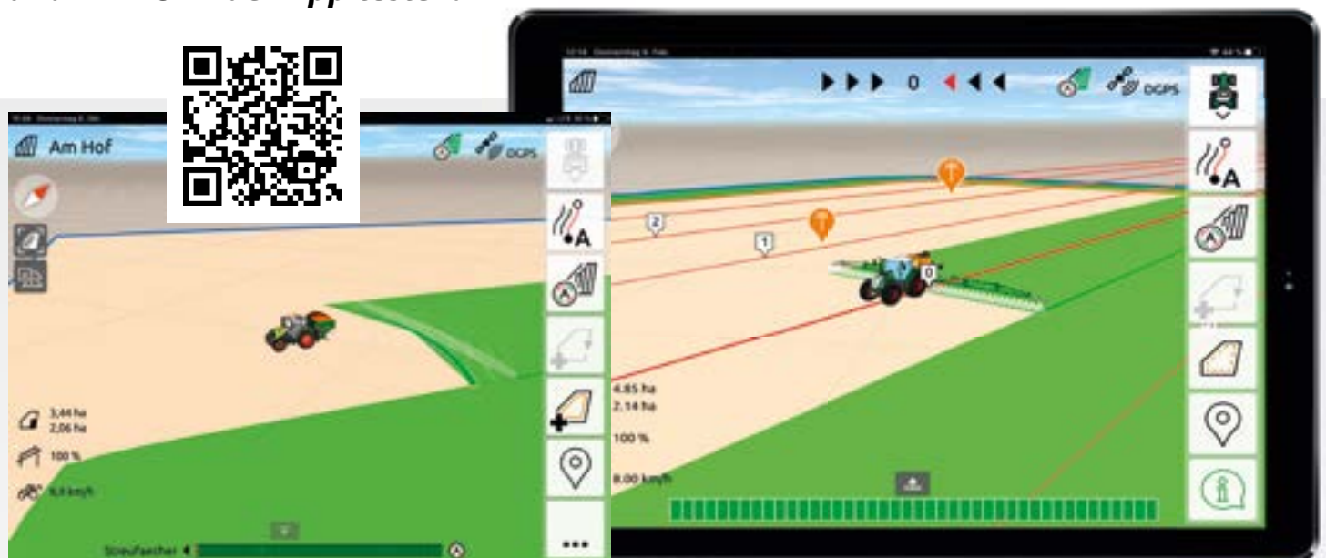
Alternative Kartenansichten mit AmaTron Twin – Übersichtliche Darstellung der Arbeitsmaschine und ihrer Teilbreiten sowie Schaltflächen auf der rechten Seite des mobilen Endgeräts.
