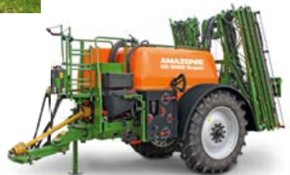
Anhängespritze UG 3000 Super mit Super-S2-Gestänge von 15 m bis 28 m
