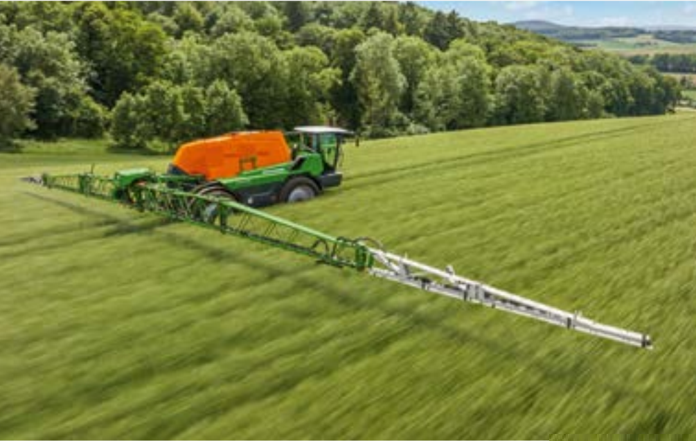
Pantera 7004 mit 36 m breitem Super-L3-Gestänge
