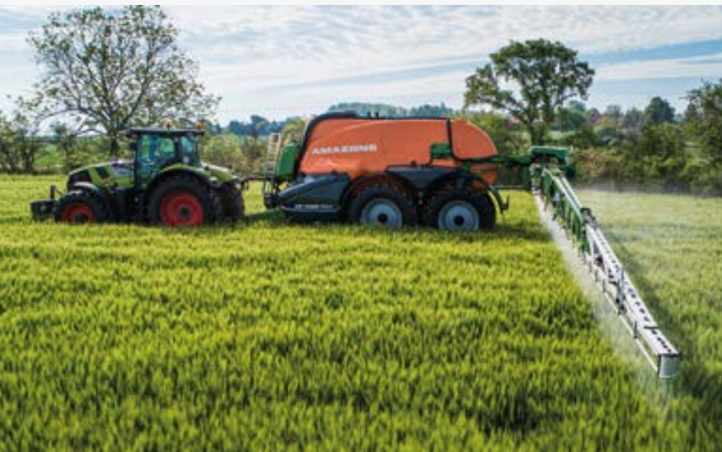
Anhängespritze UX 11201 mit 40-m-Super-L2-Gestänge
