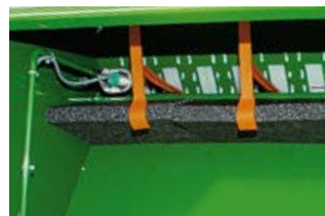
Ein optionaler Rapseeinsatz wird mit wenigen Handgriffen zur Verkleinerung der Rapsrestmengen in den Saatgutbehälter gesteckt.
