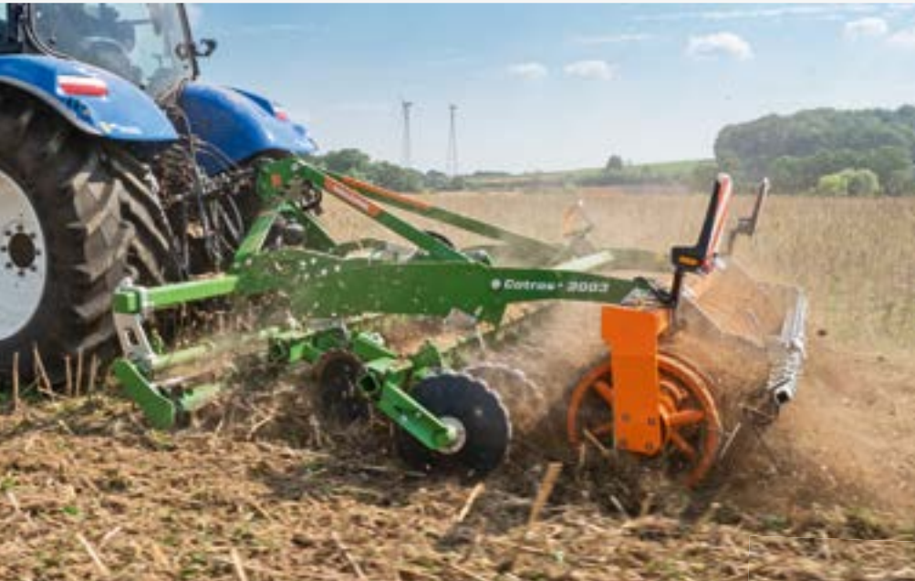
Catros + 3003 mit gezackten Scheiben in 3 m Arbeitsbreite
