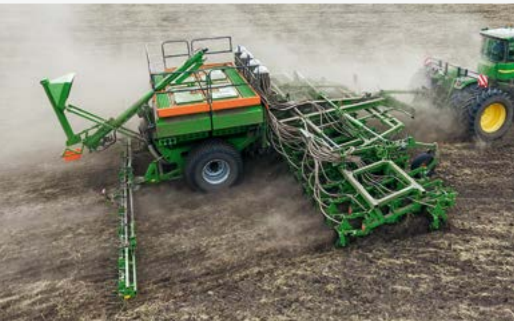
Primera DMC 12001-2C in 12 m Arbeitsbreite mit außenliegenden Verteilerköpfen
