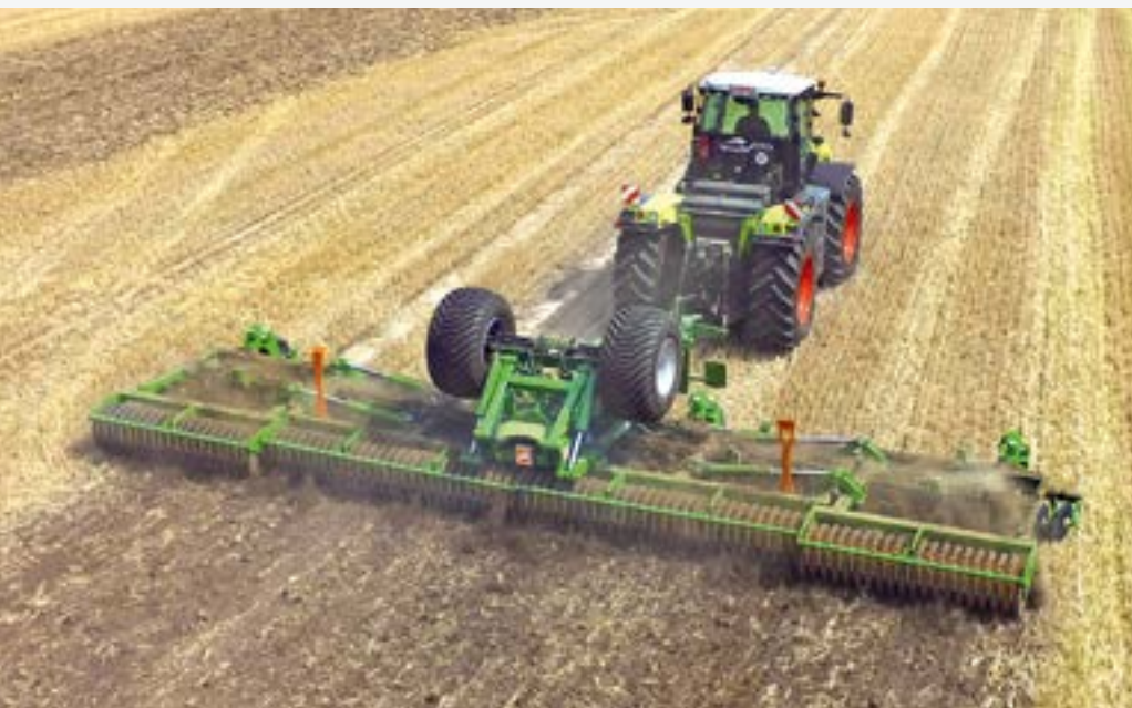
Catros + 12003-2TS in 12 m Arbeitsbreite beim Stoppelsturz
