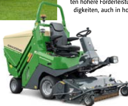
Profihopper 4WDi SmartLine mit Vorderradantrieb und 0-Wendekreis
