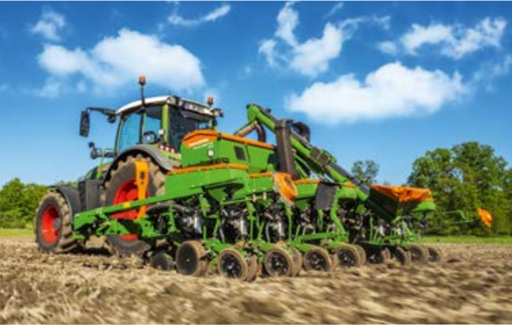
Einzelkorn-Sämaschine Precea 6000-2CC, 8-reihig im Einsatz
