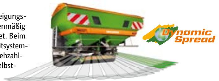
DynamicSpread: maximal 128-fache Teilbreitenschaltung beim ZA-TS
