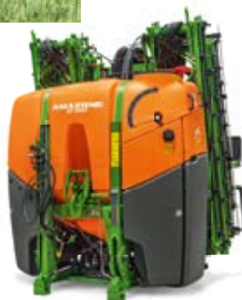
Anbauspritze UF 1602 mit 28-m-Super-S2-Gestänge
