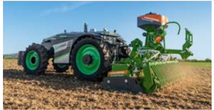
4-Rad AgXeed AgBot und AMAZONE Kreiselegge KE 3001 Super mit Aufbausämaschine GreenDrill
