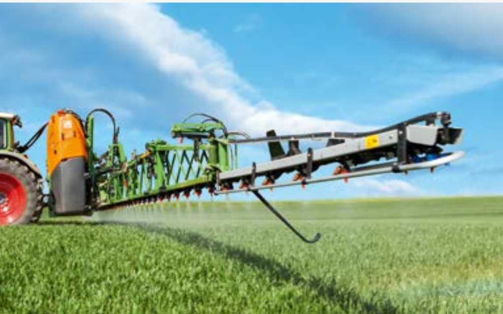
Anbauspritze UF 2002 mit 30-m-Super-S2-Gestänge
