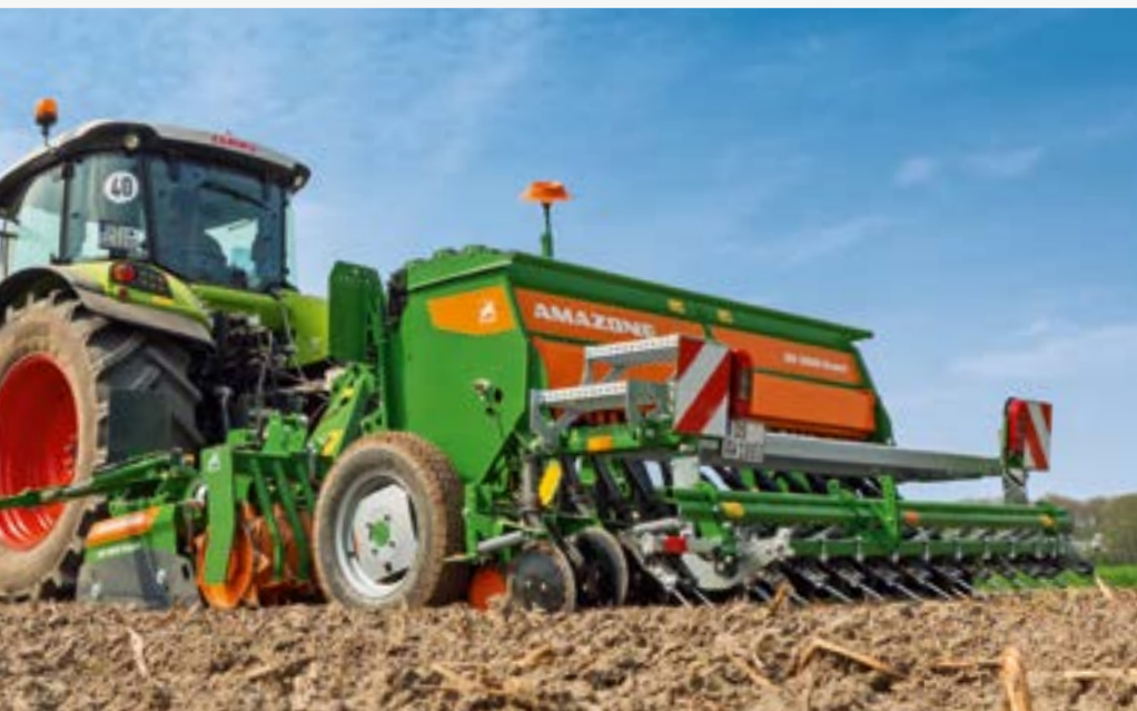
D9 3000 Super mit Exaktstriegel in Kombination mit Kreiselegge und Zahnpackerwalze
