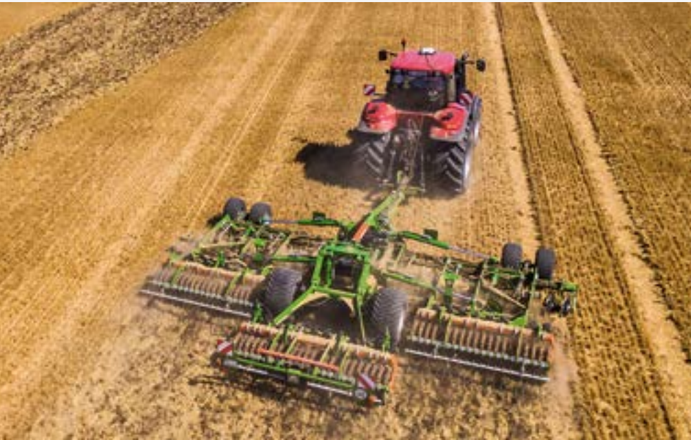
Catros + 8003-2TX mit Keilringwalzen mit Matrixreifenprofil in 8 m Arbeitsbreite
