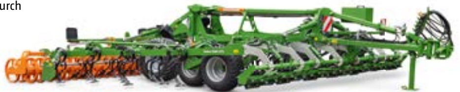
Cobra 7002-2TX mit Messerwalze
