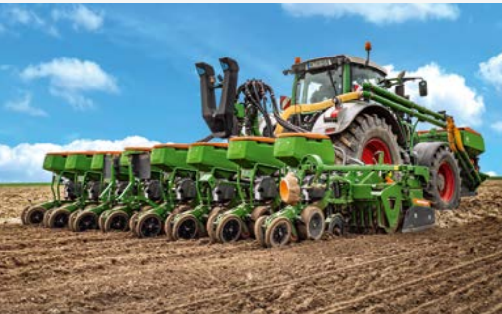
Einzelkorn-Sämaschine Precea 6000-2AFCC mit Kreiselgrubber 6002-2 Super
