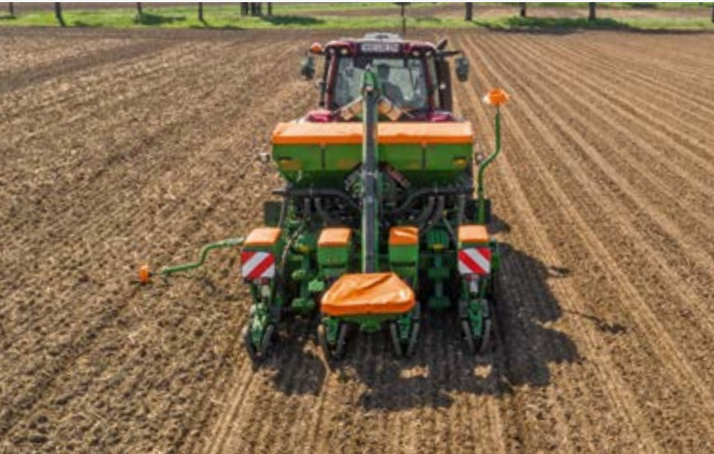
Einzelkorn-Sämaschine Precea 3000-CC, 4-reihig
