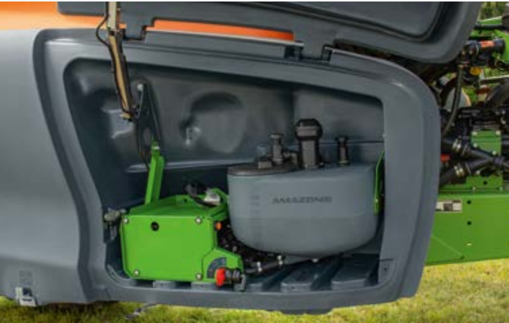
DirectInject-Ausstattung mit 50-l-Tank und Pumpeneinheit im Ablagefach der UX 01 Super
