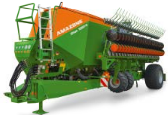
Citan 12000-C geklappt auf 3 m Transportbreite
