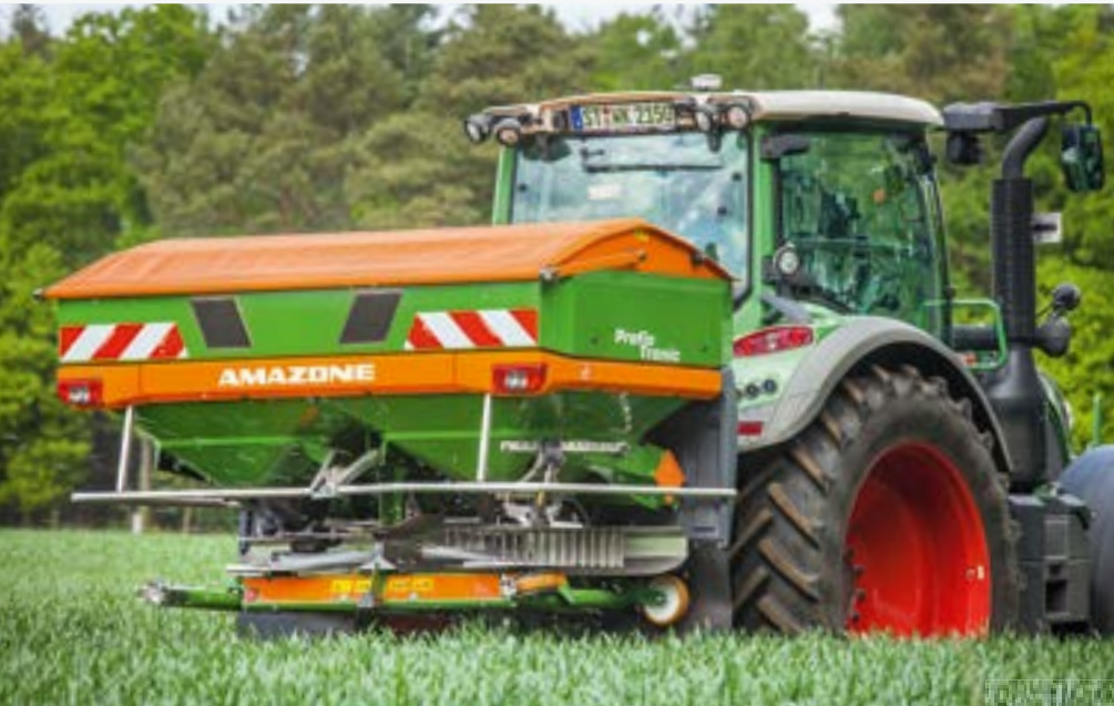
Wiegestreuer ZA-V 2000 Profis Tronic mit Limiter V+
