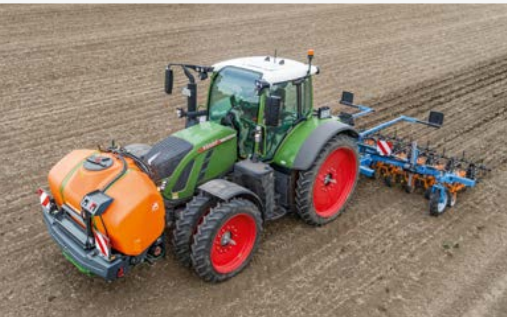
Fronttank FT-P 1502 im Einsatz mit einer SCHMOTZER Hackmaschine für die Bandspritzung
