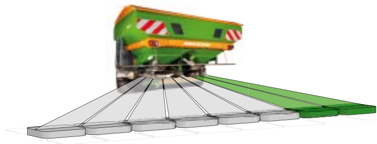
Mit der 8- oder 16-fachen Teilbreitenschaltung für den ZA-V können einzelne außenliegende Teilbreiten angesteuert werden
