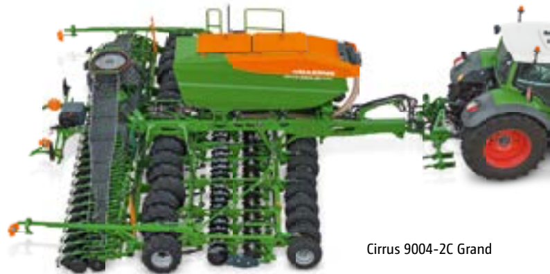
Cirrus 9004-2C Grand mit Matrixreifen für die streifenweise Rückverfestigung.
