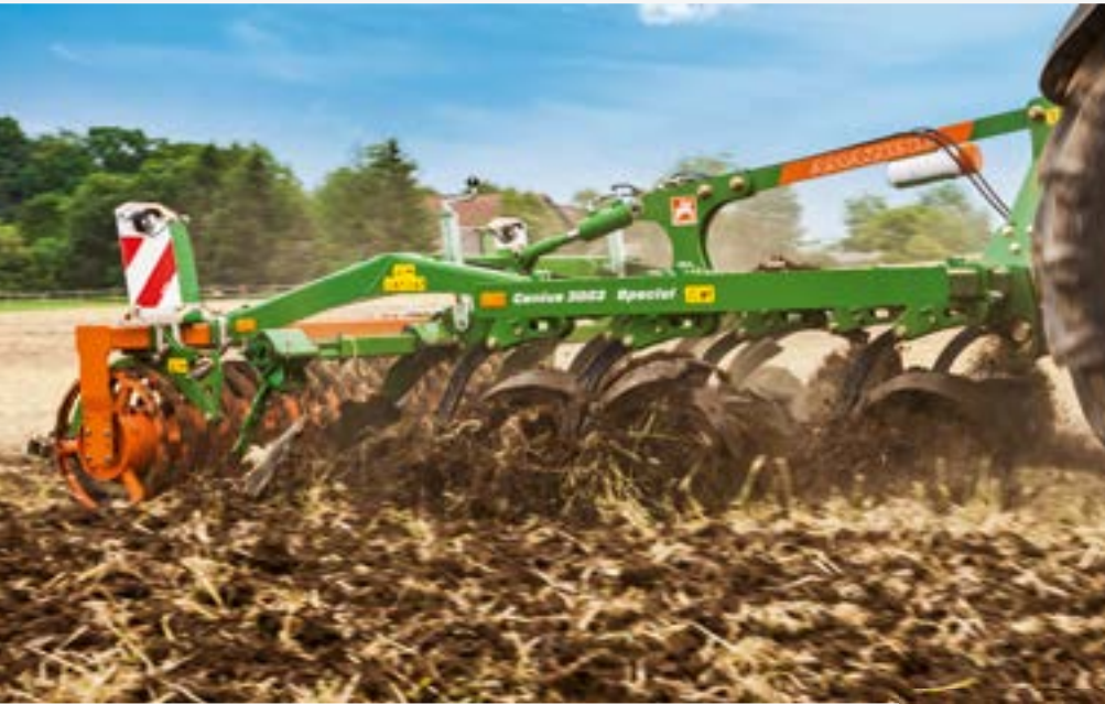
Cenius 3003 Special, 3 m mit Schneidringwalze
