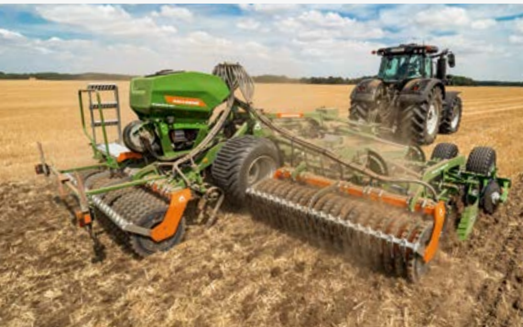
Kompaktscheibenege Catros XL 8003-2TX mit Universal-Aufbausämaschine GreenDrill 501
