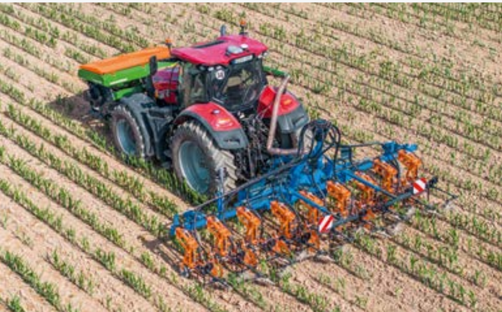
Venterra 2K in Kombination mit dem Frontanbaubehälter FTender zur Reihendüngung
