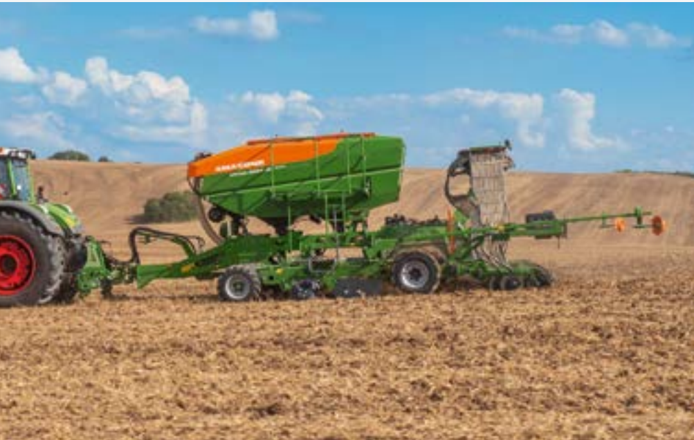
Cirrus 9004-2C Grand mit Matrixreifen für die streifenweise Rückverfestigung.
