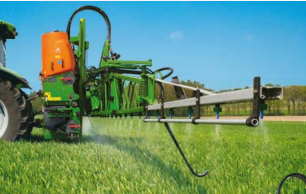
Anbauspritze UF 1201 mit 18-m-Super-S2-Gestänge
