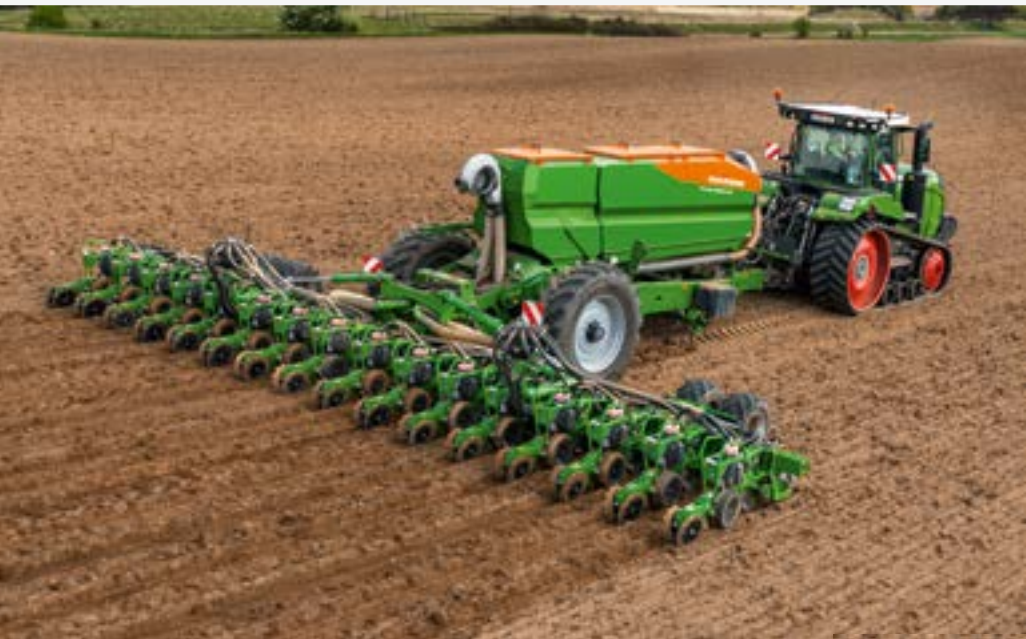
Precea 12000-TCC mit einer Arbeitsbreite von 12 m und 16 Reihen
