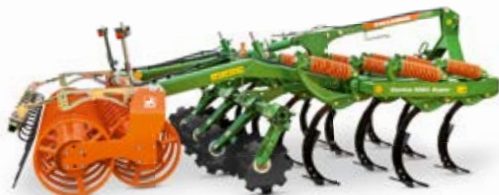
Cenius Super: C-Mix-Zinken mit 600 kg Überlastsicherung und 300 mm Aushebeweg in der Feder – ideal auch für extreme Einsatzverhältnisse.
