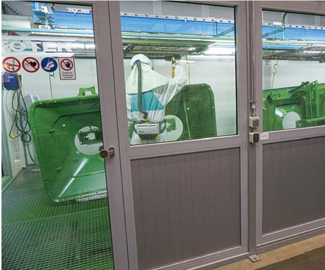
Mitarbeiter in der Pulverbeschichtungsanlage.
