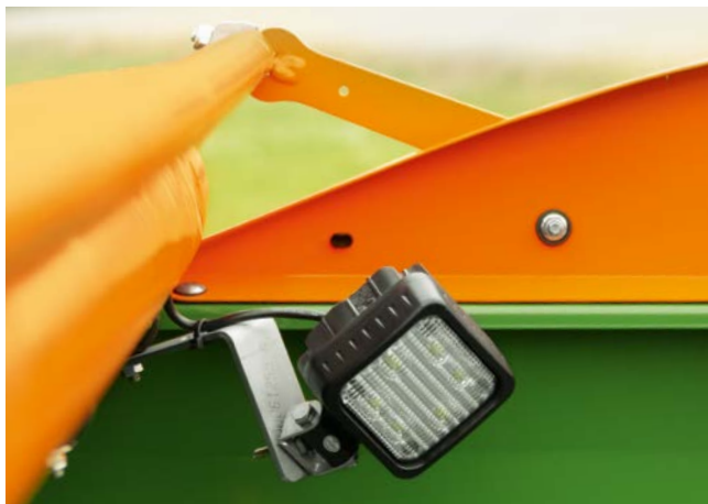
Verlichting binnenzijde van de trechter
