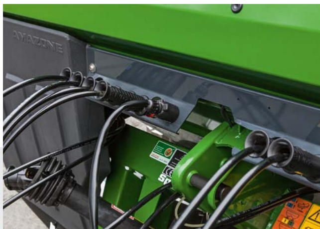
Overzichtelijk opbergen van de hydrauliekslangen
